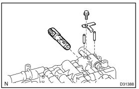
19. REMOVE SHIFT SOLENOID VALVE SL2
