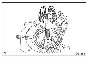
(d) Install the rear planetary gear assy.
