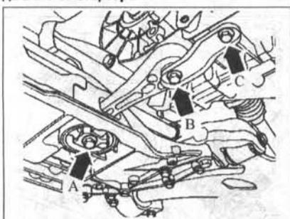
4.20 Отсоедините опору подвески с гасителем крутильных колебаний, вывинтив болты А, В и С крепления
