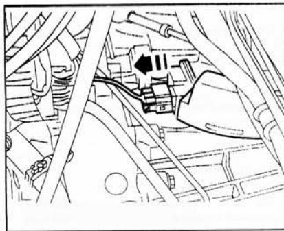
2.12 Отсоедините разъем проводов фонарей заднего хода
