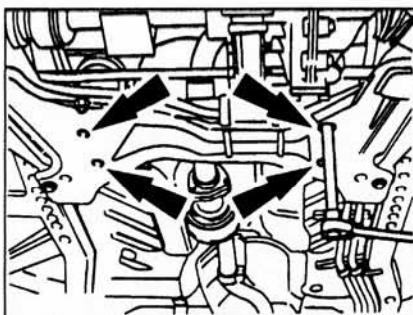
**2.103 Крепление рулевого механизма на балке переднего моста.**
