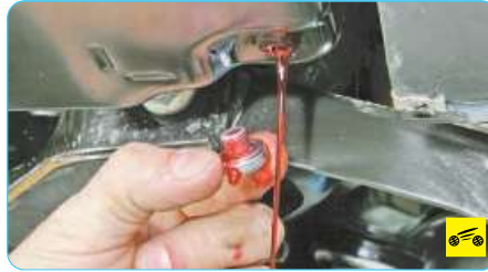
16. Выверните пробку сливного отверстия в поддоне коробки передач и слейте часть рабочей жидкости в чистую емкость (см. «Проверка уровня, доливка и замена рабочей жидкости в автоматической коробке передач», с. 122).
