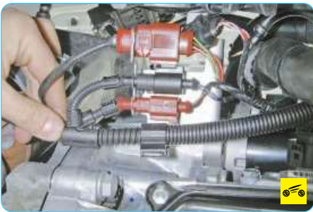
13. Извлеките из держателей на коробке передач жгуты проводов и отведите их в сторону.
