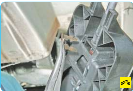
16. Захватив пассатижами, извлеките фиксирующую скобу наконечника оболочки троса из паза в нижней крышке кулисы.
