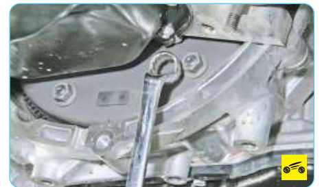
23. Через окно, открывшееся после снятия щитка, проворачивая коленчатый вал, отверните шесть гаек крепления гидротрансформатора к ведущему диску.
