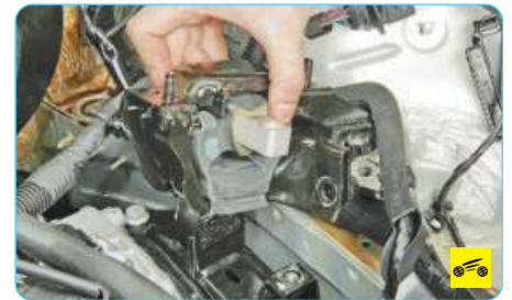
24. Снимите левую опору подвески силового агрегата (см. «Замена левой опоры подвески силового агрегата», с. 73).
