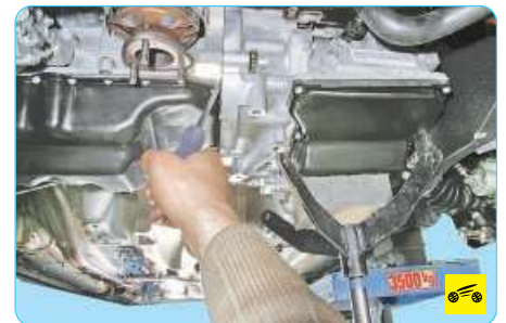
26. Вставив монтажную лопатку в специальный паз в нижней части картера гидротрансформатора, отсоедините коробку передач от двигателя, сдвиньте коробку назад...
