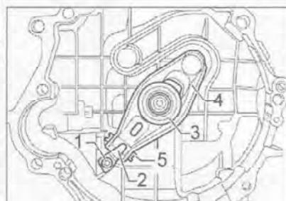
Рис. 7.166. Отверните болт (1) и снимите крепежную пластину (2). Снимите рычаг выключения сцепления (4) с выжимным подшипником (3) и проставкой (5).
