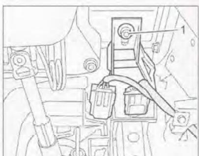
Рис. 7.321. Подведите педальный узел к перегородке моторного отсека и вставьте болт (стрелка).
