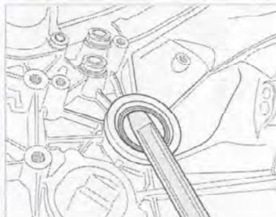
Рис. 7.352. Рычагом извлеките сальник приводного вала.
