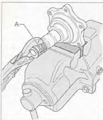
Рис. 7.353. Замените стопорное кольцо (A) приводного вала.
