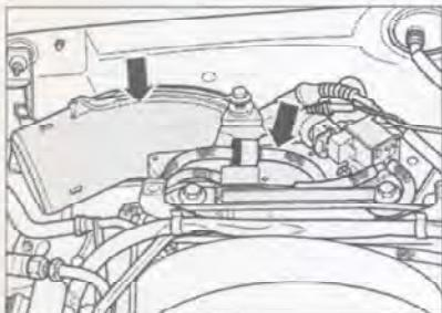
Рис. 7.32. Если установлен, снимите впускной воздуховод (стрелки) и отложите его в сторону.
