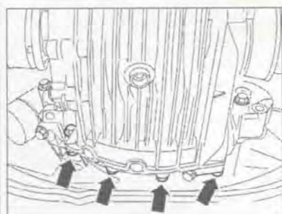
Рис. 7.37. Отверните болты крепления коробки передач со стороны двигателя (стрелки).
