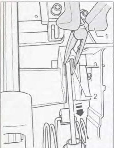
Рис. 7.313. Щипцами (1) сожмите зажим (2). Слегка вытяните педаль сцепления в направлении сиденья. Вытяните шток и зажим из педали сцепления в направлении моторного отсека (стрелка).
