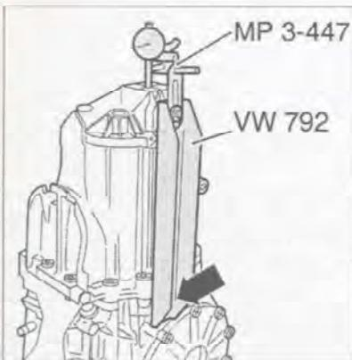
Рис. 7.151. Установите индикатор часового типа на корпус коробки передач и закрепите болтом (стрелка).
