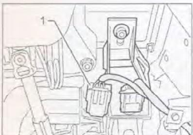
Рис. 7.312. Будьте осторожны: не выдавите датчик педали сцепления (стрелка) из держателя.
