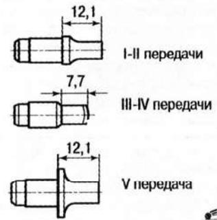
**Рис. 5.34. Размеры наконечников вилок включения передач**
