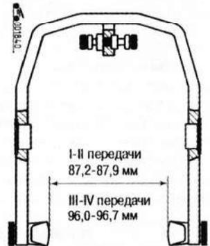
**Рис. 5.35. Измерение расстояния между наконечниками вилок включения передач**
