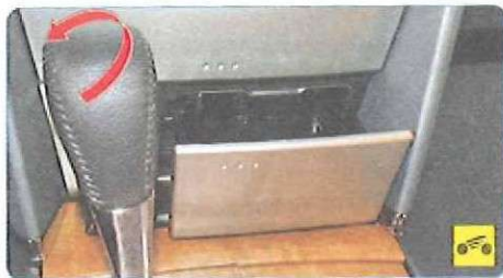
10. Поверните рукоятку рычага переключения передач против часовой стрелки и снимите ее.
