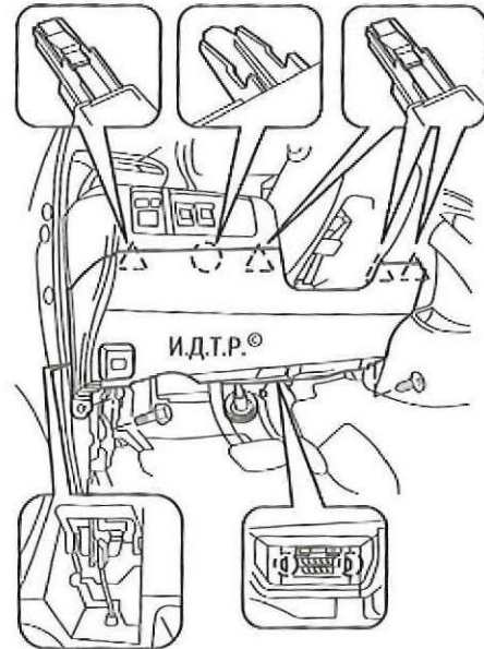
Рис. 6.11. Крепление левой нижней облицовки панели приборов
