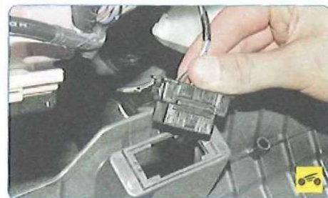
Рис. 6.10. Крепление боковой облицовки панели приборов
