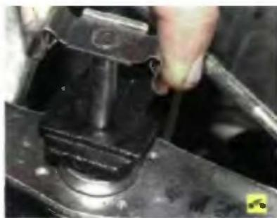
2. ...и извлеките ось из отверстий шарнира рычага и кронштейна задней опоры силового агрегата. Отведите рычаг переключения передач от кронштейна.
