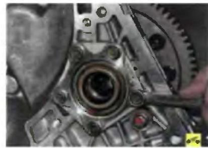
69. Выверните пять болтов крепления крышки правого подшипника дифференциала, снимите крышку, снимите с нее уплотнительное кольцо, затем выпрессуйте из крышки сальник и при необходимости наружное кольцо подшипника так же, как выпрессовывали их из регулировочной гайки.
