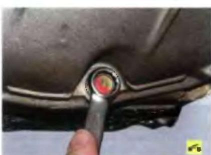
17. Выверните болты крепления картера коробки передач к блоку цилиндров двигателя, расположенные рядом со стартером...
