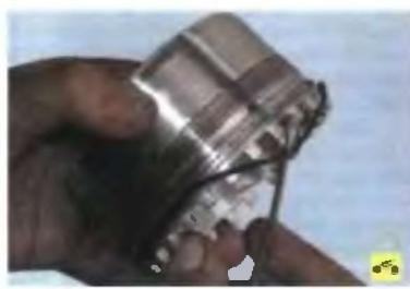
65. Снимите с гайки уплотнительное кольцо.
