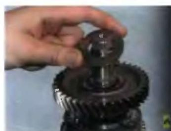
4. Перед установкой вторичного вала в промежуточный картер сожмите круглогубцами стопорное кольцо и зафиксируйте проволокой в сжатом состоянии. Снимите проволоку после установки вала в картер, убедившись, что кольцо вошло в проточки картера без перекосов.
