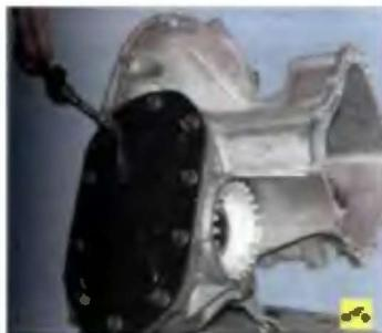
59. Выверните десять болтов крепления нижней крышки коробки передач ...
