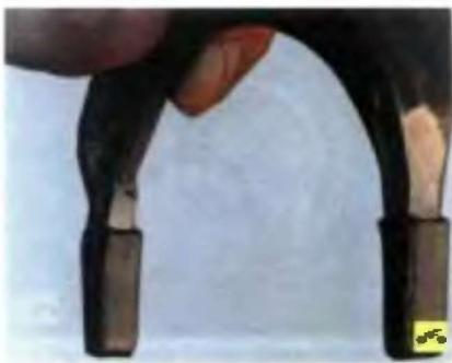
75. Проверьте состояние вилок переключения передач. Если вилки погнуты либо изношены лапки, замените эти детали.
