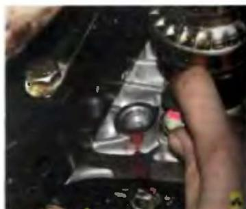
9. ...до момента его появления из контрольного отверстия. Заверните пробку контрольного отверстия.
