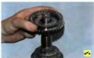
13. ...и снимите с вала синхронизатор
