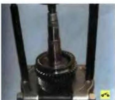
12. Спрессуйте со шлицев вала синхронизатор I и II передач вместе с ведомой шестерней II передачи, прикладывая усилие к торцу шестерни.
