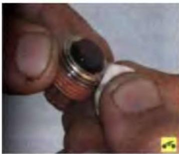
В пробке установлен магнит для сбора металлических продуктов износа, очистите его перед установкой.
