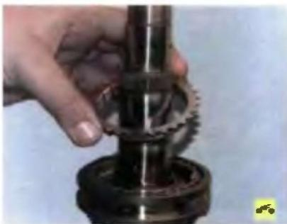
23. ...и блокирующее кольцо синхронизатора III передачи.
