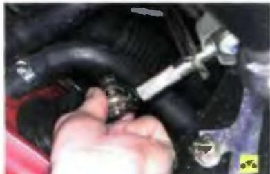
6. ...и разъедините тягу и наконечник рычага переключения передач.
