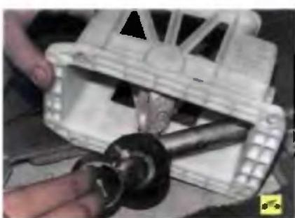
12. Снимите корпус и извлеките из него вал.
