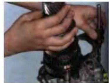
55. Извлеките из картера хвостовик вторичного вала и снимите вал в сборе, а также шток и вилку переключения I и II передач.
