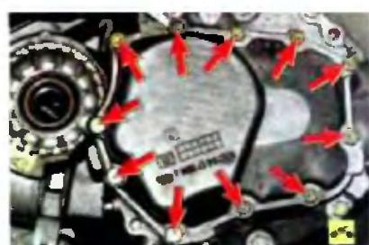
16. Выверните одиннадцать болтов крепления задней крышки коробки передач...
