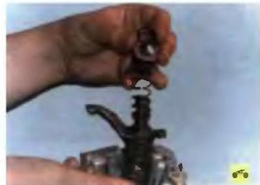
6. ...и снимите с оси переключателя передач стопорное кольцо, плоскую шайбу, пружину...
