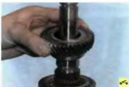
21. Снимите с вала ведомую шестерню III передачи...
