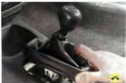
4. В салоне извлеките из передней части облицовки тоннеля пола рамку чехла рычага управления коробкой передач, преодолевая усилие ее фиксаторов.
