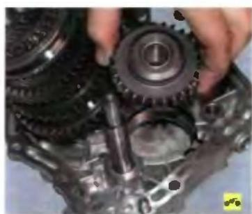
54. Снимите промежуточную шестерню заднего хода.
