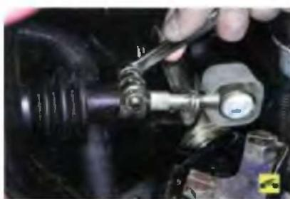
3. В моторном отсеке ослабьте затяжку клеммового соединения привода переключения передач, обеспечив свободное взаимное перемещение наконечника рычага переключения передач и тяги.
