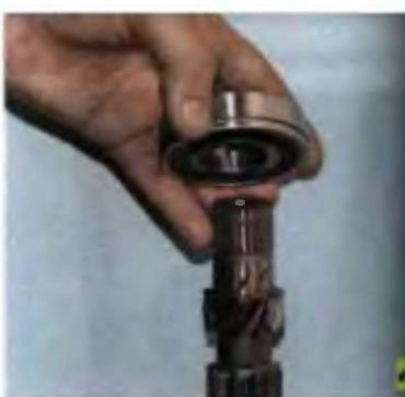
31. ...и задний роликовый подшипник вторичного вала.
