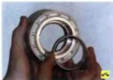
68. Извлеките дистанционное кольцо из регулировочной гайки.
