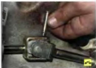
8. ...и извлеките ось шарнира привода переключения передач. Разъедините вилки шарнира.
