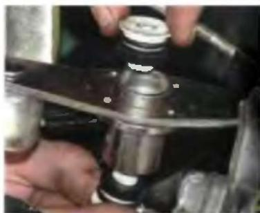
3. Извлеките две пластмассовые втулки шарнира из отверстий рычага.
