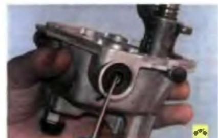
4. Поддев отверткой, извлеките из гнезда крышки сальник вала переключения.
