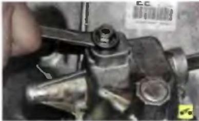
3. ...и извлеките ось шарнира привода переключения передач. Разъедините вилки шарнира.
