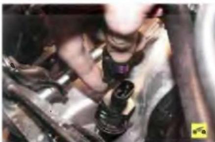
7. Отсоедините колодки моторного жгута проводов от датчика скорости...
