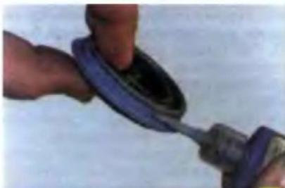
3. ...и устанавливайте сальники с применением анаэробного фиксатора резьбы.
