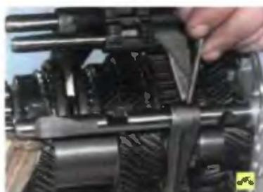
44. Оперев свободный конец штока на деревянный бруск, выбейте бородком штифт крепления вилки включения промежуточной шестерни заднего хода...
