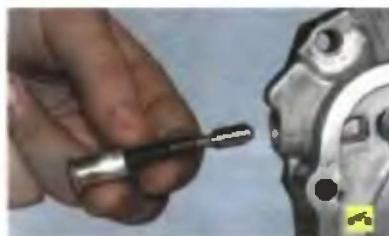
39. ...отличается от двух других. После выпрессовки пробок извлечите из гнезд промежуточного картера пружины и фиксаторы штоков.
