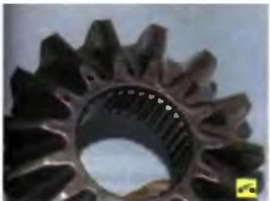
12. ...шилицы и зубья полуосевых шестерен, при сильном износе рабочих поверхностей, шлицев и зубьев, выкрашивании зубьев замните шестерни дифференциала.
