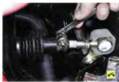
1. В моторном отсеке ослабьте гайку болта клеммового соединения наконечника рычага и тяги переключения передач.
