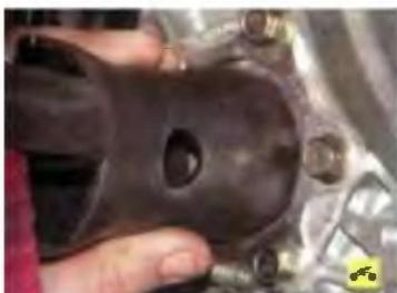
3. Смажьте рабочую кромку нового сальника трансмиссионным маслом и запрессуйте его оправкой подходящего размера рабочей кромкой внутрь коробки.
