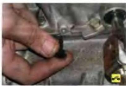
1. Извлеките пробку регулировочного отверстия из крышки механизма переключения передач (рис. 6.5).
