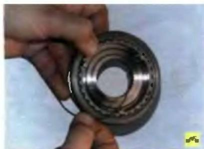
3. ...снимите две пружины.
