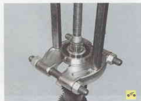
4. Спрессуйте задний подшипник первичного вала с шейки блока шестерен...
