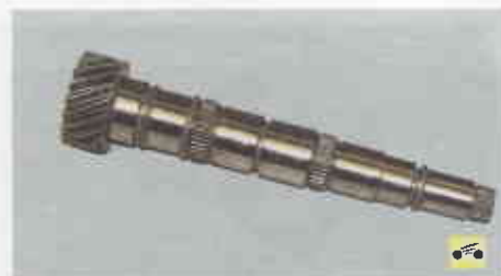
36. Осмотрите вторичный вал и его детали:
