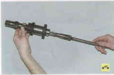
8. Извлеките собственно первичный вал из блока шестерен.
