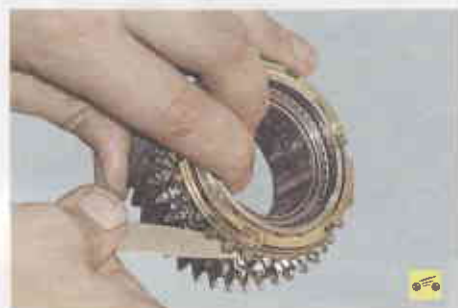
4. Спрессуйте задний подшипник первичного вала с шейки блока шестерен...
