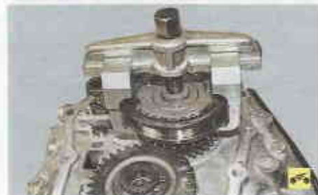
30. Установите универсальный съемник на муфту синхронизатора V передачи...
