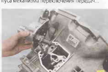
13. Выверните четыре болта крепления корпуса механизма переключения передач...
