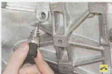
12. ...и снимите выключатель.
