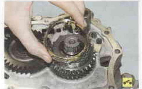
32. Снимите блокирующее кольцо синхронизатора...
