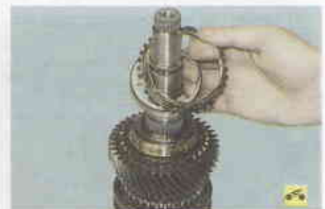
16. Снимите наружное блокирующее кольцо, промежуточное кольцо...
