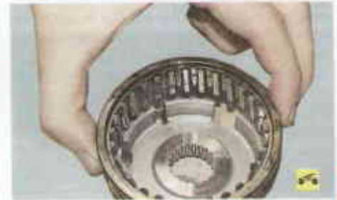
6. ...и снимите муфту со ступицы.
