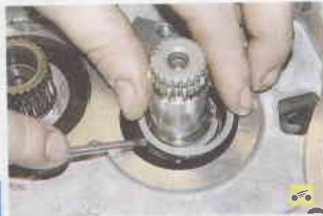
38. Снимите с вторичного вала запорное кольцо...
