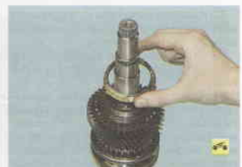
16. Снимите наружное блокирующее кольцо, промежуточное кольцо...
