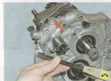
63. Молотком через зубило с притупленным жалом выбейте пробки фиксаторов штоков вилок переключения передач...
