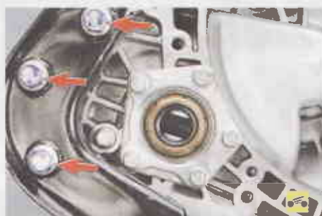
9. Выверните три болта крепления кронштейна задней опоры силового агрегата и снимите кронштейн.
