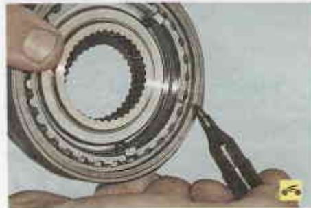
1. Перед разборкой промаркируйте положение муфты относительно ступицы.
