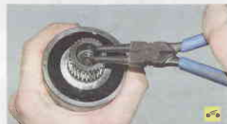
1. Сожмите съемником стопорное кольцо первичного вала...
