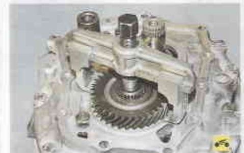
36. ...установите универсальный съемник на ведущую шестерню V передачи...
