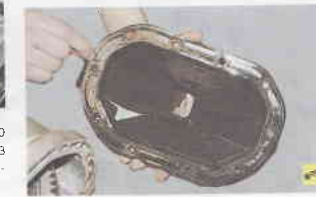
45. ...и снимите крышку вместе с прокладкой.
