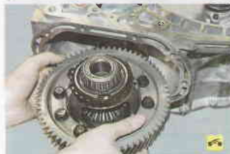
57. Извлеките дифференциал в сборе из картера коробки передач.
