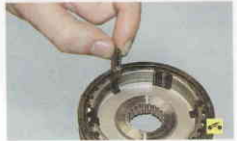
5. ...выньте из пазов ступицы три сухаря...
