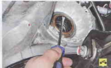
Рис. 6.9. Расположение пробки отверстия для заливки рабочей жидкости в автоматическую коробку передач
