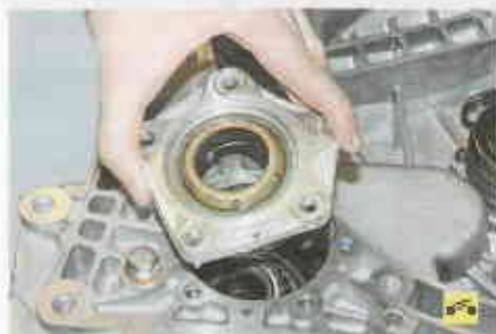
56. ...снимите крышку, снимите с нее уплотнительное кольцо, выпрессуйте из крышки сальник и при необходимости наружное кольцо подшипника так же, как выпрессовывали их из регулировочной гайки.
