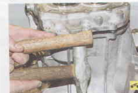
41. ...отделите промежуточный картер от картера коробки ударами молотка через деревянную проставку, опертую о специальный прилив картера.
