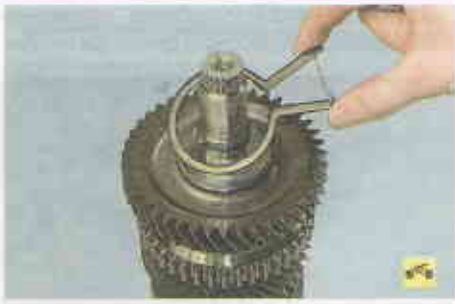
3. Снимите, сжав усики, пружинное стопорное кольцо...
