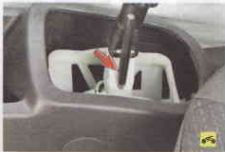
Рис. 6.12. Расположение пробки регулировочного отверстия: 1 – вал переключения передач; 2 – крышка механизма переключения передач; 3 – пробка регулировочного отверстия; 4 – переключатель передач
