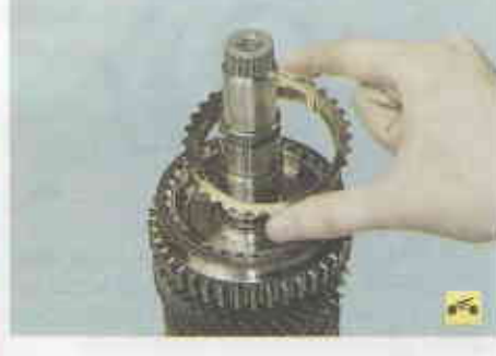
10 ... и наружное блокирующее кольцо синхронизатора I передачи.
