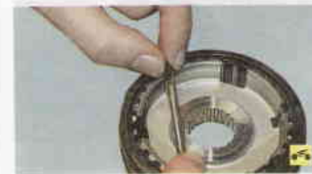
11. На ступице не должно быть забоин шлицев и следов износа.
