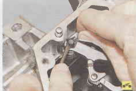
16. Поддев отверткой пружинный фиксатор поводка вилки включения V передачи...
