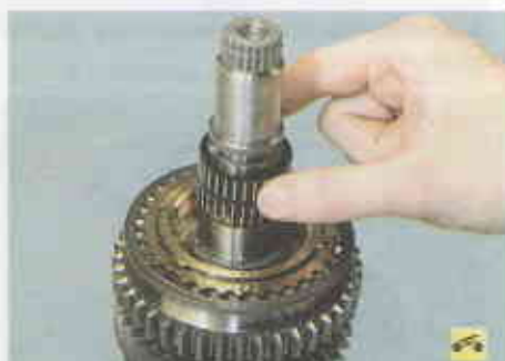
7 ... игольчатый подшипник ведомой шестерни I передачи...
