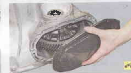
45. ...и снимите крышку вместе с прокладкой.
