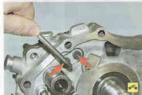
61. Выверните два болта крепления кронштейна собачки...
