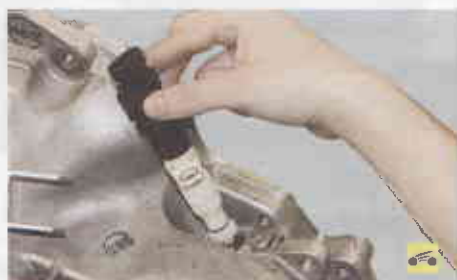
10. Снимите привод спидометра вместе с датчиком скорости автомобиля (см. «Проверка и замена датчиков системы управления двигателем», с. 227).
