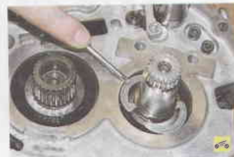
39. ...и извлеките два упорных полукольца
