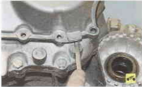
23. Поддев отверткой край крышки в районе специально предназначенного для этого прилива, отделите крышку от прокладки.
