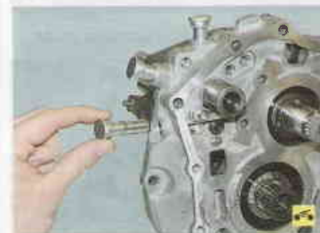
64. ...и извлеките фиксаторы.
