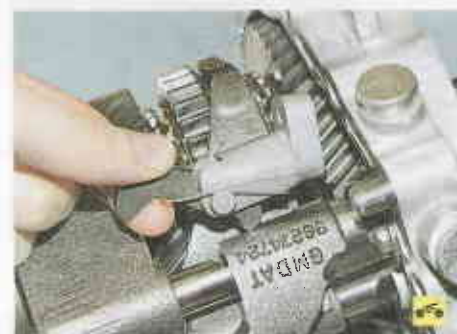
62. ...установите штоки вилок последовательно в положение II, V и III передач и снимите кронштейн в сборе с собачкой.
