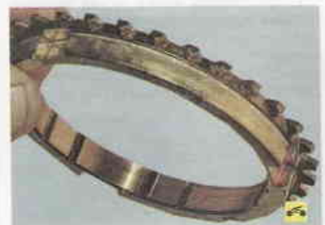
10. ...и блокирующих колец не должно быть выкрашивания и замятия.
