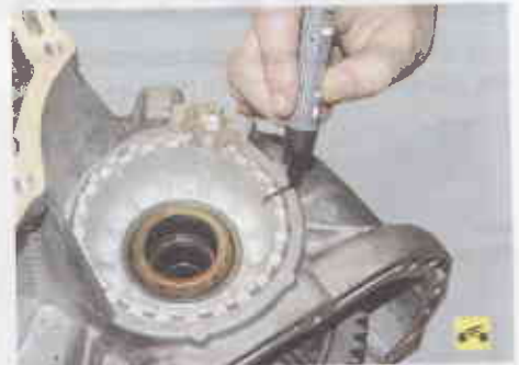
47. Пометьте положение регулировочной гайки подшипников дифференциала относительно картера коробки передач...
