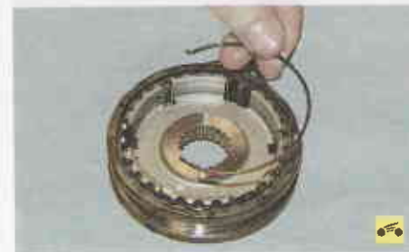
3. ...снимите две пружины.
