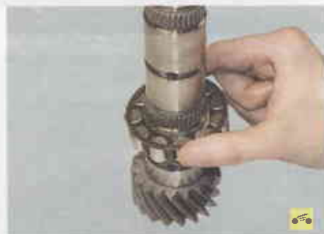
35. ...и задний роликовый подшипник вторичного вала.
