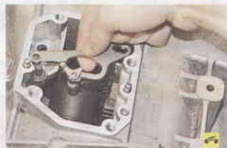
18. ...и снимите поводок.
