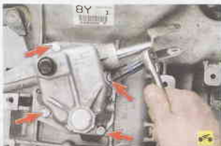
13. Выверните четыре болта крепления корпуса механизма переключения передач...
