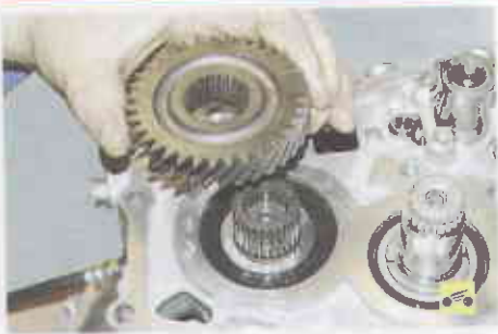
37. ...и спрессуйте шестерню с вала.
