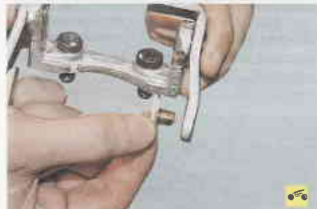
29. Снимите с вилки сухари.
