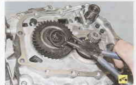
35. Снимите стопорное кольцо ведущей шестерни V передачи...
