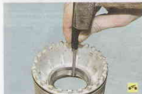
54. При необходимости замены подшипников дифференциала переверните регулировочную гайку, подложите пару деревянных брусков и выпрессуйте из гайки наружное кольцо подшипника дифференциала.
