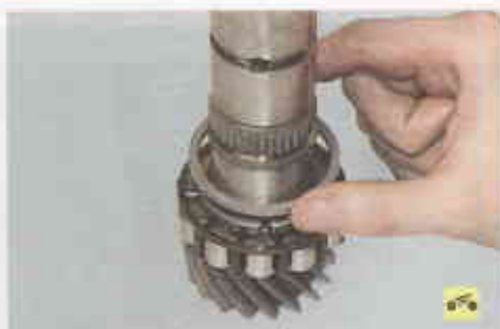
33. Снимите с вала запорное кольцо...
