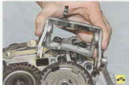
28. ...и снимите кронштейн в сборе с вилкой.
