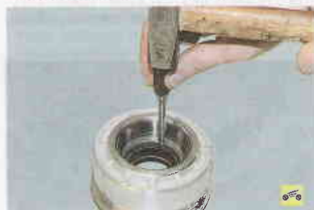
53. Выпрессуйте из гайки сальник полуоси.
