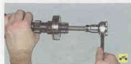
2. ...и извлеките его из проточки блока шестерен.
