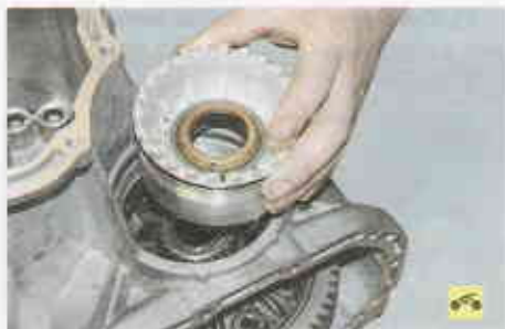
51. ...и, подсчитывая число оборотов, выверните гайку.
