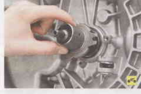
21. ...и направляющую втулку подшипника (см. «Замена сальников коробки передач», с. 150).
