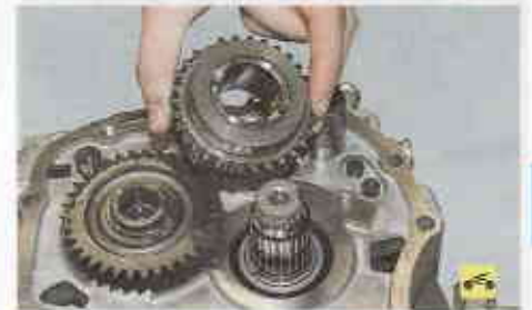
33. ...ведомую шестерню V передачи...
