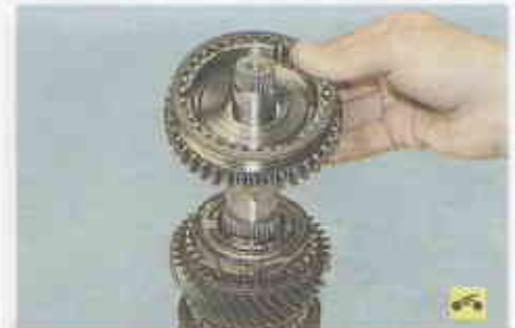
15 ... и снимите с вала синхронизатор.
