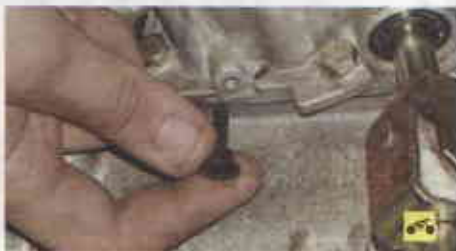
Рис. 6.12. Расположение пробки регулировочного отверстия: 1 – вал переключения передач; 2 – крышка механизма переключения передач; 3 – пробка регулировочного отверстия; 4 – переключатель передач
