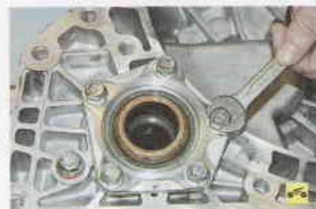
54. При необходимости замены подшипников дифференциала переверните регулировочную гайку, подложите пару деревянных брусков и выпрессуйте из гайки наружное кольцо подшипника дифференциала.
