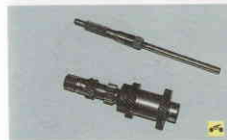
10. ...и разъедините блоки шестерен.
