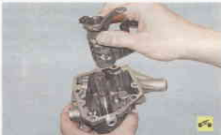
Рис. 6.11. Привод переключения передач (для наглядности снят с автомобиля): 1 – ось шарнира привода переключения передач; 2 – вал переключения передач; 3 – рычаг переключения передач; 4 – шарнир рычага переключения передач; 5 – наконечник рычага переключения передач; 6 – ось рычага переключения передач; 7 – тяга выбора передач; 8 – фиксатор оси шарнира привода переключения передач; 9 – шарнир вала переключения передач
