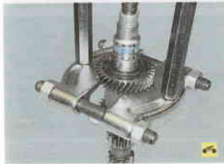
9. При необходимости спрессуйте блок шестерен III и IV передач с шеек блока шестерен I и II передач, а также передачи заднего хода.
