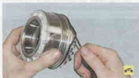
52. Снимите с гайки уплотнительное кольцо.
