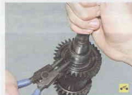
6. Разожмите стопорное кольцо блока ведущих шестерен III и IV передач...
