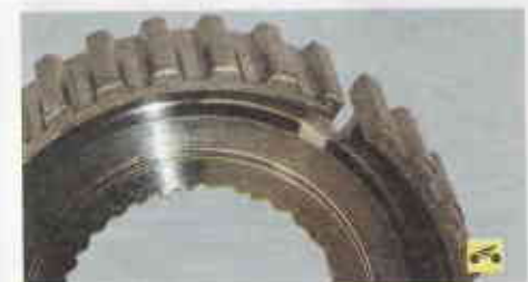
11. На ступице не должно быть забоин шлицев и следов износа.
