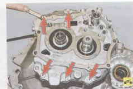
40. Выверните пять болтов крепления промежуточного картера к картеру коробки передач...
