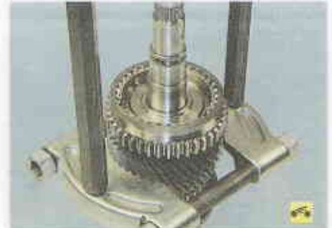
14. Спрессуйте со шлицев вала синхронизатор I и II передачи вместе с ведомой шестерней II передачи, прикладывая усилие к торцу шестерни...
