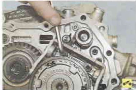
27. Выверните два болта крепления кронштейна вилки включения V передачи...
