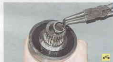
2. ...и извлеките его из проточки блока шестерен.
