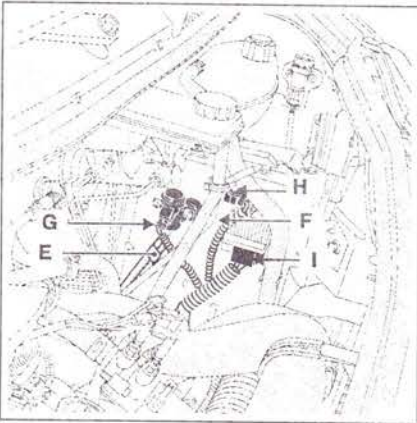
Рис. 5.14. Отсоедините трубки Е и Ф , разъемы проводки Г , Н и И .
