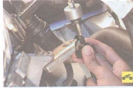
15. Отсоедините от вилки выключения сцепления и кронштейна на коробке передач трос привода выключения сцепления (см. «Замена и регулировка троса привода выключения сцепления», с. 115).
