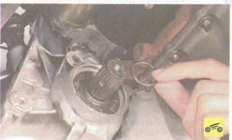
3. Снимите с хвостовика полуосевой шестерни резиновое уплотнительное кольцо.
