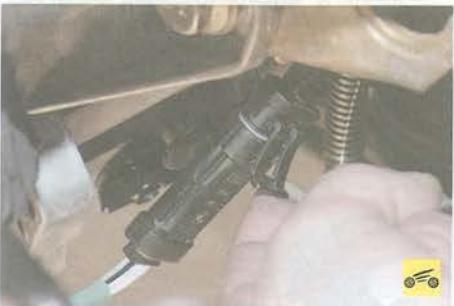
22. Отжав фиксатор колодки жгута проводов датчика концентрации кислорода...
