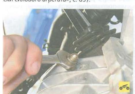
38. Отверните две гайки нижнего крепления коробки передач к двигателю слева...
