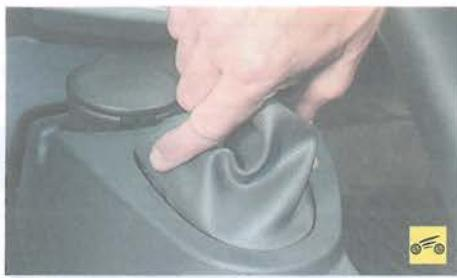
4. ...выньте нижний держатель чехла из отверстия в облицовке тоннеля пола...
