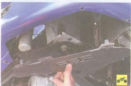
2. Снимите защиту картера и нижнюю часть левого брызговика двигателя (см. «Снятие и установка брызговиков и защиты картера двигателя», с. 68).
