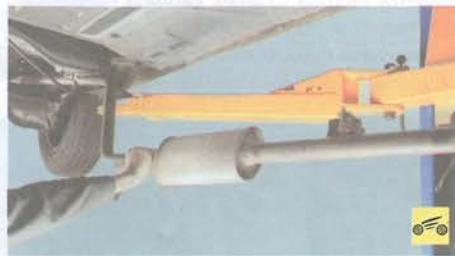
1. Отсоедините крепления (см. «Замена элементов системы выпуска отработавших газов», с. 99) и отведите в сторону систему выпуска отработавших газов.
