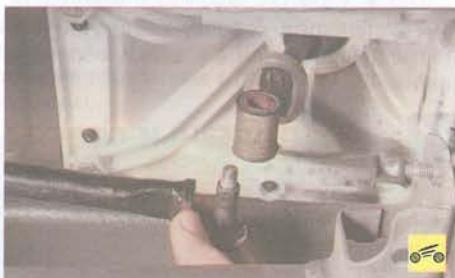
2. Отсоедините от нижнего конца рычага управления коробкой передач тягу привода управления коробкой передач (см. «Замена тяги привода управления коробкой передач», с. 121) и отведите тягу в сторону.
