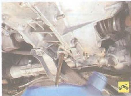
3. Слейте масло из коробки передач (см. «Проверка уровня и доливка в коробку передач», с. 49).
