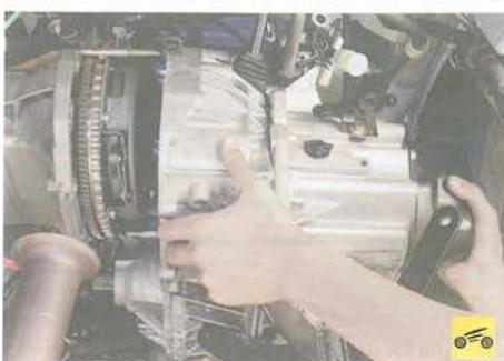
40. Сдвиньте коробку передач назад до момента выхода шпилек картера сцепления из отверстий блока цилиндров. При этом первичный вал коробки должен выйти из ступицы ведомого диска сцепления.
