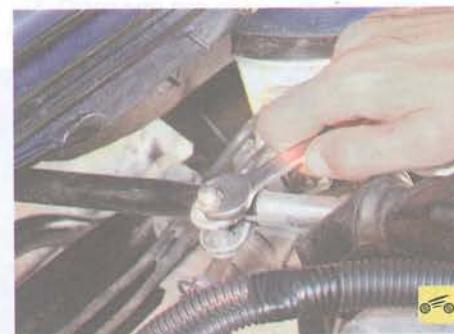
9. Ослабьте затяжку стяжного хомута крепления тяги управления коробкой передач к ее рычагу...
