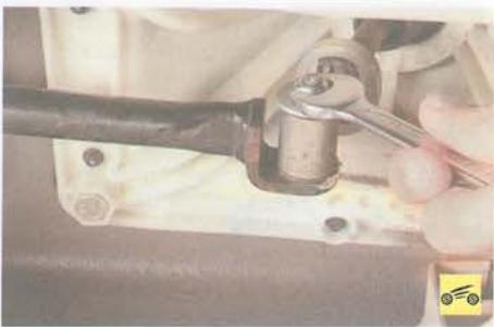
3. Снизу автомобиля отверните гайку пальца тяги привода управления коробкой передач...
