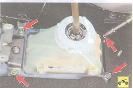
7. Отверните четыре гайки крепления кулисы к основанию кузова...
