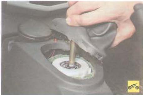
5. ...и снимите чехол, сдвинув его вверх по рычагу.
