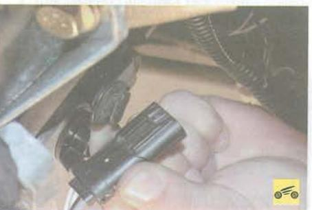
24. ...и снимите колодку жгута с держателя на коробке передач.
