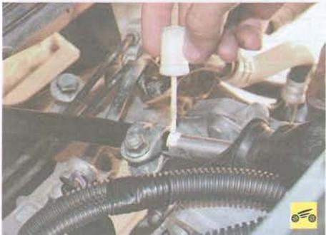
Для предупреждения нарушения регулировки привода, выполняя работы, связанные с разъединением его элементов, предварительно помечайте любым доступным способом взаимное расположение деталей. При обратной сборке устанавливайте элементы привода в соответствии с нанесенными метками.
