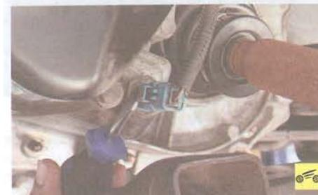
17. Поддев отверткой фиксатор колодки жгута проводов выключателя света заднего хода...
