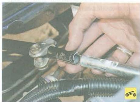
1. В моторном отсеке отсоедините тягу привода управления коробкой передач от рычага коробки (см. пп. 9–12 «Снятие и установка коробки передач», с. 118).
