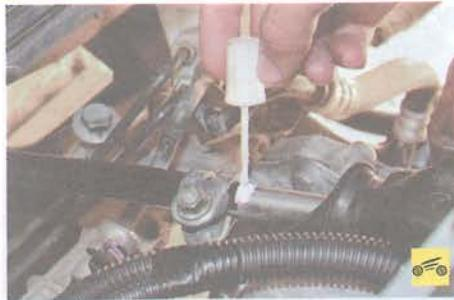
10. ...пометьте любым доступным способом (например, краской) взаимное расположение тяги и рычага, чтобы при обратной сборке не нарушить регулировку привода...
