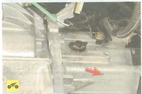
Идентификационные данные коробки передач нанесены клеймением на нижней части ее картера. Расшифровка идентификационных данных приведена на рис. 6.4.
