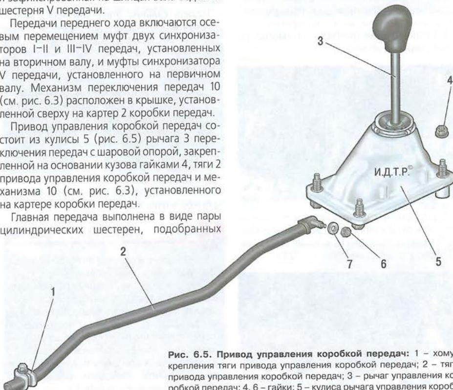
Рис. 6.5. Привод управления коробкой передач: 1 – хомут крепления тяги привода управления коробкой передач; 2 – тяга привода управления коробкой передач; 3 – рычаг управления коробкой передач; 4, 6 – гайки; 5 – кулиса рычага управления коробкой передач; 7 – шайба
