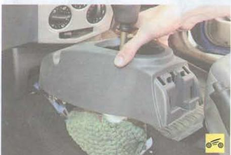
6. Снимите облицовку тоннеля пола (см. «Снятие и установка облицовки тоннеля пола», с. 208) и установленный под облицовкой шумоизоляционный чехол.
