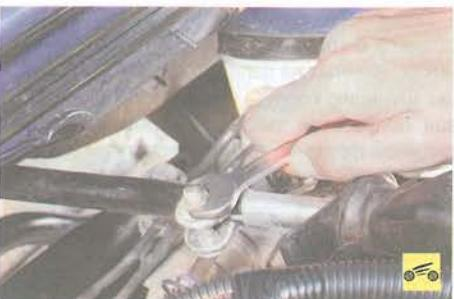
10. ...и снимите рычаг вместе с опорой.
