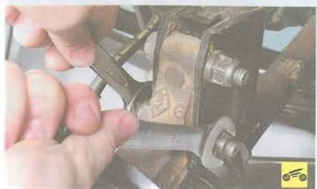
29. ...отверните по две гайки крепления амортизаторных стоек к поворотным кулакам и выньте болты из отверстий кулаков и стоек.
