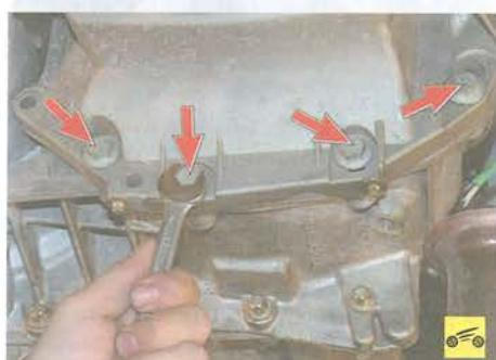
32. Выверните четыре болта крепления масляного картера к картеру сцепления.
