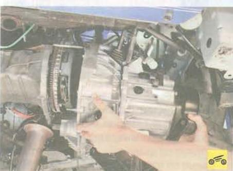
41. Сдвиньте коробку максимально назад, уберите из-под нее опору и, наклонив заднюю часть коробки вниз, снимите ее с автомобиля.
