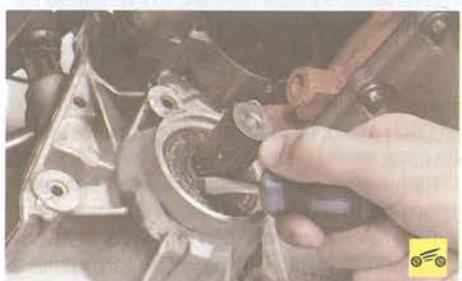
4. Поддев отверткой, извлеките сальник из гнезда в картере коробки передач.
