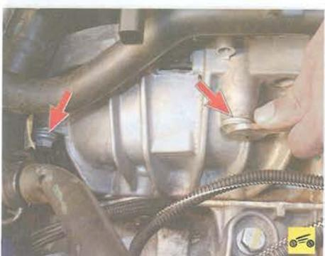
34. Выверните два верхних болта крепления коробки передач к двигателю.
