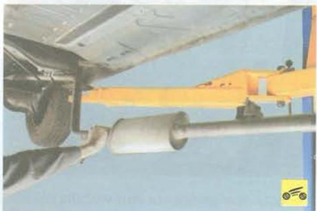
2. Отсоедините крепления (см. «Замена элементов системы выпуска отработавших газов», с. 99) и отведите в сторону систему выпуска отработавших газов.
