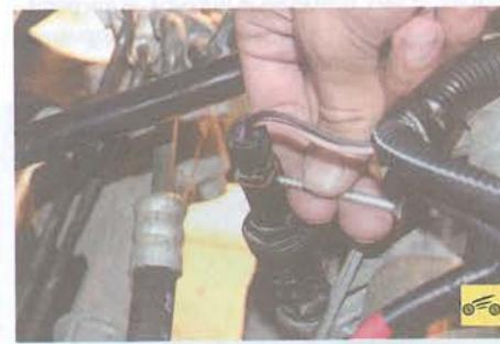
13. Нажмите каким-либо заостренным предметом на фиксатор колодки жгута проводов датчика скорости...
