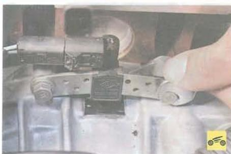
20. Выверните два болта крепления датчика верхней мертвоточки к картеру сцепления...
