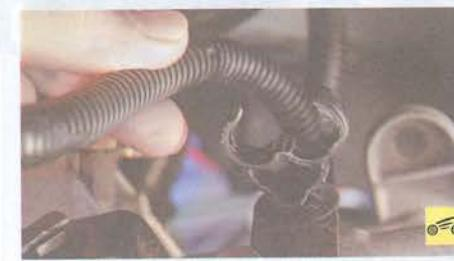
19. Выньте моторный жгут из держателя на коробке передач и отведите его в сторону.
