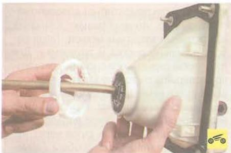
9. Для замены рычага управления коробкой передач снимите крышку кулисы, повернув ее против часовой стрелки настолько, чтобы штифты горловины кулисы вышли из пазов крышки...
