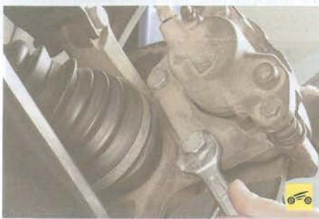
26. С обеих сторон автомобиля выверните по два болта крепления суппортов передних тормозных механизмов к поворотным кулакам...
