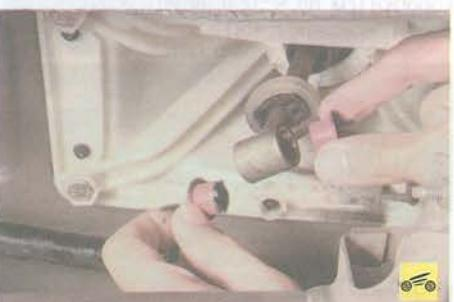
6. Если при движении автомобиля наблюдалась вибрация рычага управления коробкой передач, замените две пластмассовые втулки в нижней головке рычага.
