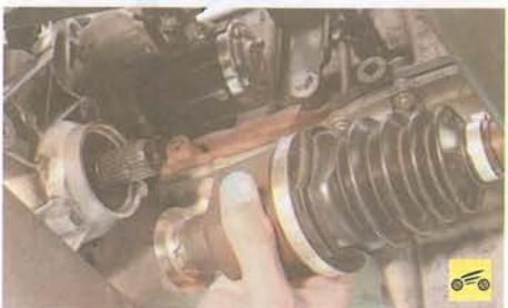
2. Для замены сальника хвостовика правой полуосевой шестерни дифференциала снимите правый привод (см. «Снятие и установка приводов передних колес», с. 124).
