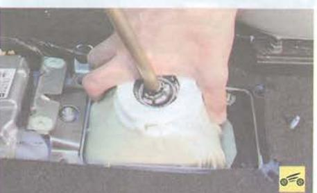
8. ...и, опустив вниз кулису через проем в основании кузова, снимите ее с автомобиля.
