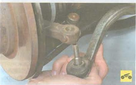
28. ...отсоедините от рычагов поворотных кулаков рулевые тяги (см. «Замена наружного наконечника рулевой тяги», с. 143)...
