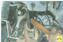
6. Извлеките сальник отверткой.
