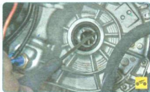
6. Извлеките сальник отверткой.
