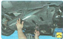
2. Снимите защиту картера...
