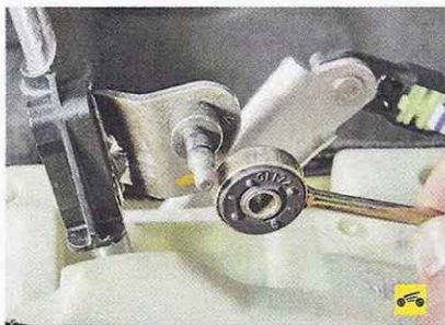
14. ...и снимите тягу переключения передач со шпильки механизма переключения передач.
