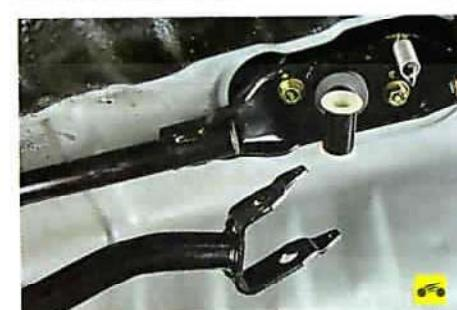
4. ...и снимите тягу привода переключения передач с автомобиля.
