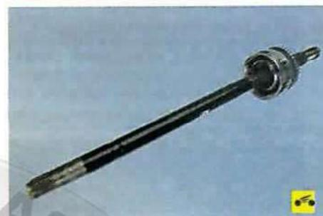
**Не пытайтесь разобрать наружные шарниры приводов передних колес! Они представляют собой неразборную конструкцию и заменяются в сборе с валами приводов.**
