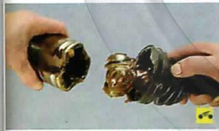
14. ...и снимите с вала защитный чехол.
