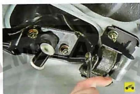
6. Отверните гайку оси демпфера рычага переключения передач...
