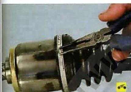
12. ...и снимите кольцо, выведя его из проточки вала.
