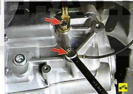
10. Выверните два болта клемм «массовых» проводов и снимите клеммы с коробки передач.
