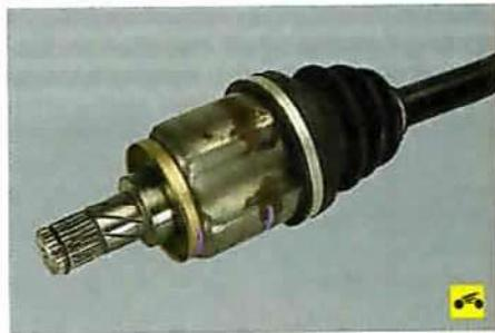
– внутренний шарнир должен перемещаться в угловых и осевых направлениях с легким усилием, при этом не должно наблюдаваться рывков, заеданий и радиальных люфтов. В противном случае замените внутренний шарнир;
