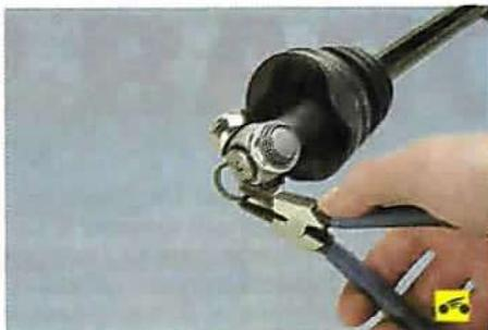
7. Снимите хомут крепления чехла внутреннего шарнира к валу привода...
