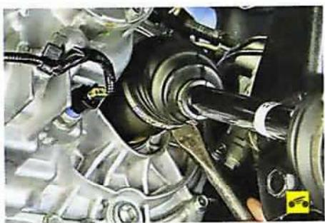
10. С помощью монтажной лопатки выпрессуйте хвостовик внутреннего шарнира из шестерни полуоси дифференциала...
