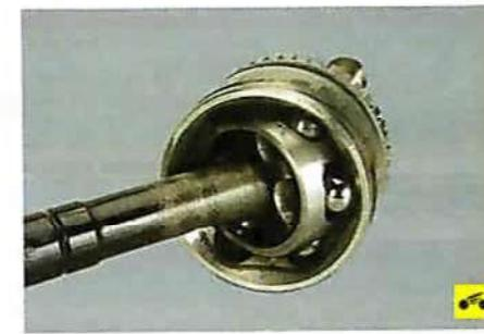
– наружный шарнир равных угловых скоростей должен поворачиваться с легким усилием, без рывков и заеданий, радиальных и осевых люфтов. При их наличии замените шарнир;
