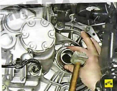
3. Смажьте рабочую кромку нового сальника трансмиссионным маслом и запрессуйте его оправкой подходящего диаметра рабочей кромкой внутрь коробки.
