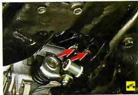
9. Отверните две гайки шпилек крепления кронштейна реактивной тяги к кронштейну на коробке передач и снимите реактивную тягу.
