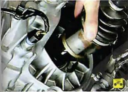
2. Снимите приводы передних колес (см. «Снятие и установка приводов передних колес», с. 135).
