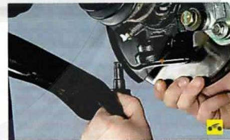
8. Отсоедините рычаг передней подвески от поворотного кулака (см. «Снятие и установка рычага передней подвески», с. 141).
