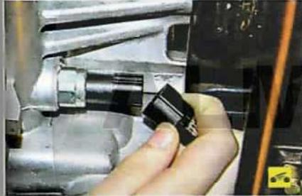
4. Отсоедините колодку жгута проводов от выключателя света заднего хода (см. «Замена выключателя света заднего хода», с. 199).
