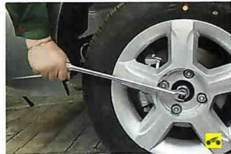
4. Отверните гайку ступицы и ослабьте затяжку гаек крепления колеса.
