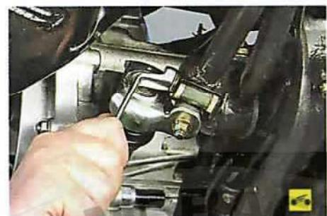
8. Отверните гайку оси крепления тяги выбора передач к втулке механизма выбора...
