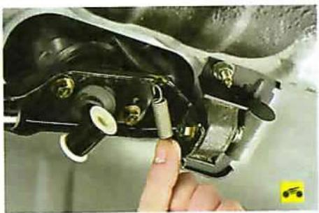
5. Снимите возвратную пружину.
