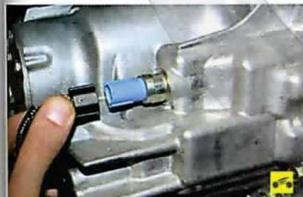
5. Отсоедините колодку жгута проводов от датчика нейтрального положения в коробке передач...
