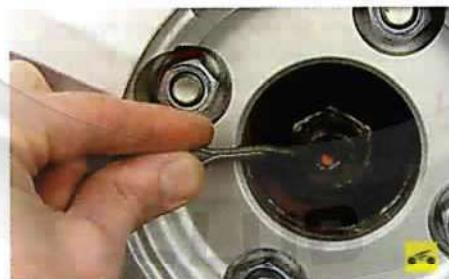
3. Расстопорите гайку ступицы, вынув шплинт.
