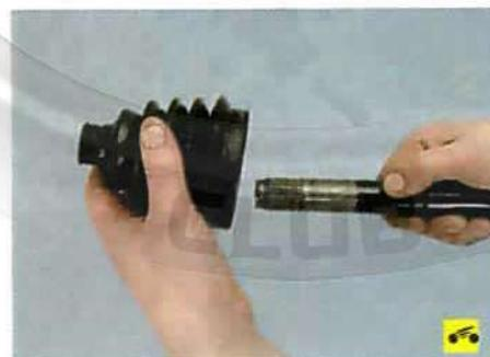
10. Отсоедините от привода корпус внутреннего шарнира.
