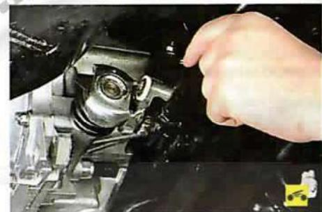
9. ...извлеките ось и снимите кронштейн тяги с втулки.
