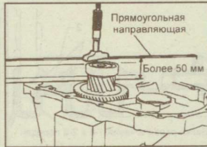
Рис. 9.259. Измерение расстояния от верхней поверхности прямоугольной направляющей до установочной поверхности наружного кольца подшипника
