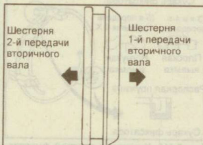
Рис. 9.101. Установочное положение скользящей муфты синхронизатора
