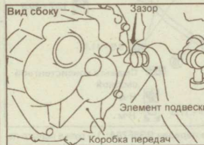
Рис. 9.30. Снятие коробки передач с автомобиля
