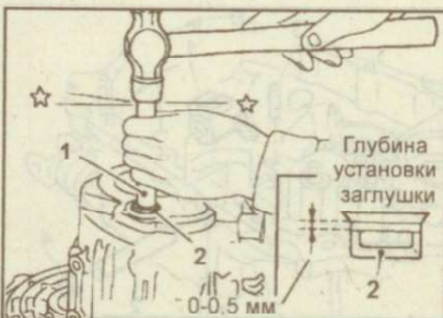
Рис. 9.160. Использование молотка и выколотки (1) для установки технологической заглушки (2)
