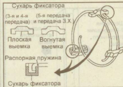
Рис. 9.110. Установка сухарей фиксаторов на распорную пружину
