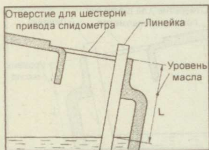
Рис. 9.1. Проверка уровня трансмиссионного масла в коробке передач
