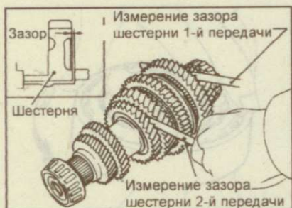
Рис. 9.221. Проверка зазоров шестерен 1-й и 2-й передач вторичного вала
