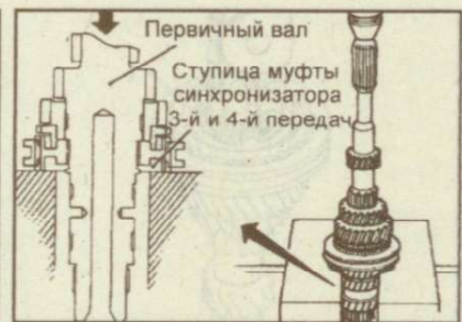
Рис. 9.214. Установка ступицы муфты синхронизатора 3-й и 4-й передач
