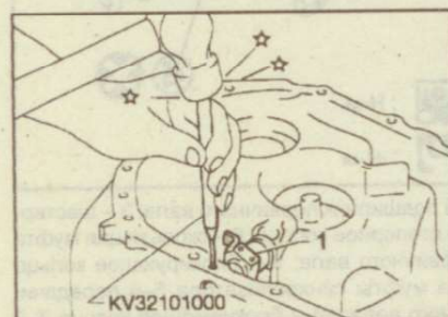
Рис. 9.193. Выбивание штифта крепления вала селектора (1)
