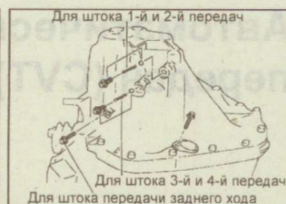
Рис. 9.278. Установка болтов и пробок
