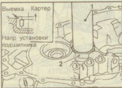
Рис. 9.145. Использование оправки (1) для установки переднего подшипника (2) вторичного вала
