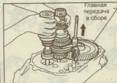
Рис. 9.191. Снятие первичного и вторичного валов
