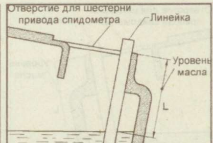
Рис. 9.6. Проверка уровня трансмиссионного масла
