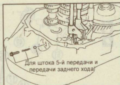
Рис. 9.189. Снятие пробки, пружины и шарика механизма фиксации 5-й передачи
