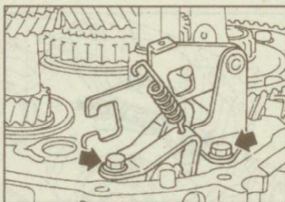
Рис. 9.272. Расположение болтов крепления рычага передачи заднего хода
