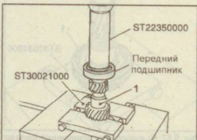
Рис. 9.75. Установка на первичный вал (1) шестерни 3-й передачи
