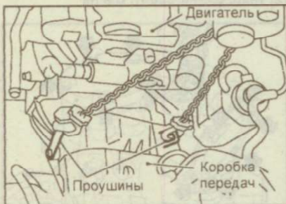
Рис. 9.26. Использование цепи и грузоподъемного механизма для поддержки двигателя
