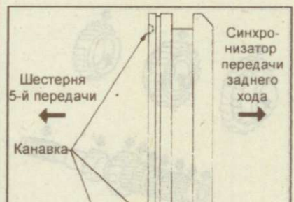
Рис. 9.217. Установка сухарей фиксатора с блокирующим кольцом передачи заднего хода в скользящую муфту синхронизатора
