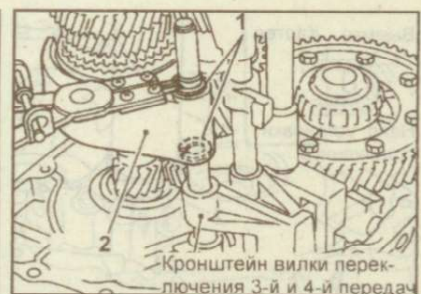
Рис. 9.158. Снятие стопорного кольца (1) вилки (2) переключения 3-й и 4-й передач
