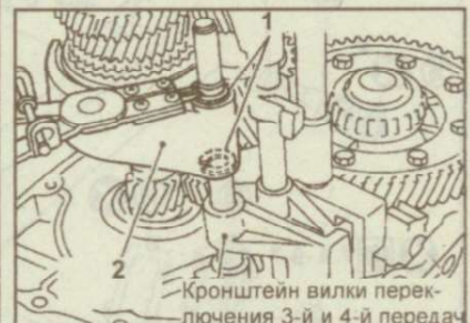
Рис. 9.46. Снятие стопорного кольца (1) вилки (2) переключения 3-й и 4-й передач
