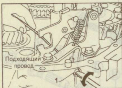
Рис. 9.187. Снятие вала (1) рычага передачи заднего хода
