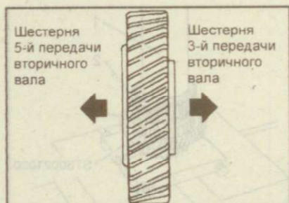
Рис. 9.106. Установочное положение шестерни 4-й передачи
