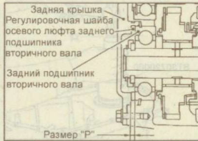
Рис. 9.173. Место измерения размера "P"
