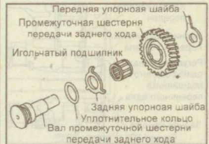
Рис. 9.177. Установка деталей промежуточной шестерни передачи заднего хода
