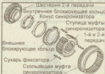
Рис. 9.236. Установка элементов синхронизатора 1-й и 2-й передач
