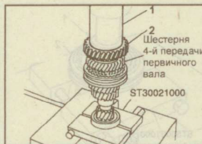
Рис. 9.83. Использование оправки (1) для установки шестерни 5-й передачи (2)
