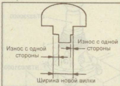
Рис. 9.137. Места проверки ширины рабочей части вилки переключения передач
