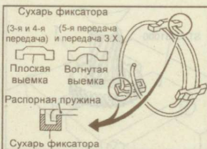
Рис. 9.76. Установка сухарей фиксаторов на распорную пружину
