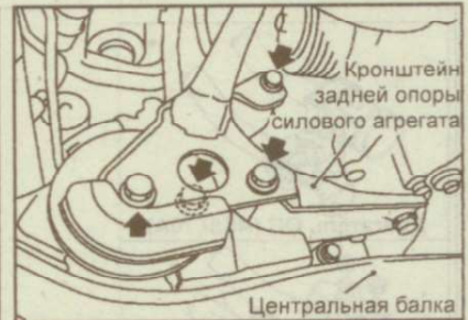
Рис. 9.25. Расположение болтов крепления кронштейна задней опоры силового агрегата
