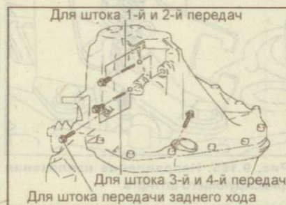
Рис. 9.181. Расположение болтов и пробок, которые необходимо снять перед разборкой коробки передач
