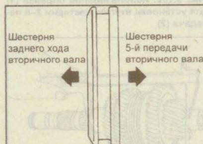
Рис. 9.112. Установочное положение скользящей муфты синхронизатора
