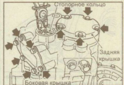
Рис. 9.179. Расположение болтов крепления задней и боковой крышки
