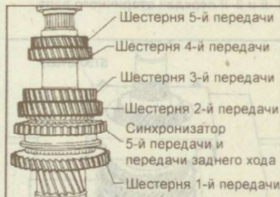
Рис. 9.233. Расположение шестерен и синхронизаторов на вторичном валу
