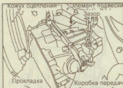
Рис. 9.29. Отделение коробки передач от двигателя
