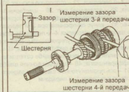
Рис. 9.197. Проверка зазоров шестерен 3-й и 4-й передач первичного вала
