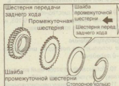
Рис. 9.115. Установочное положение промежуточной шестерни, шайбы промежуточной шестерни и стопорного кольца
