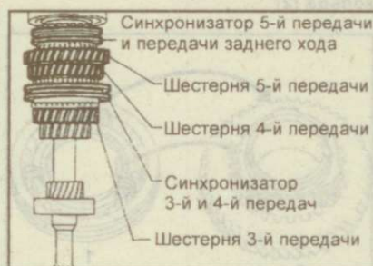
Рис. 9.211. Расположение шестерен и синхронизаторов на первичном валу
