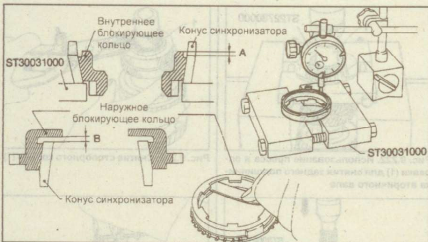
Рис. 9.231. Проверка износа блокирующих колец 1-й и 2-й передач
