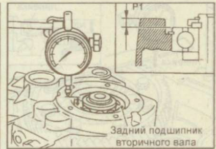
Рис. 9.174. Место измерения размера "P1"
