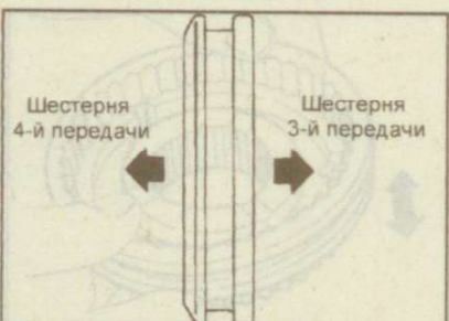
Рис. 9.78. Установочное положение скользящей муфты синхронизатора
