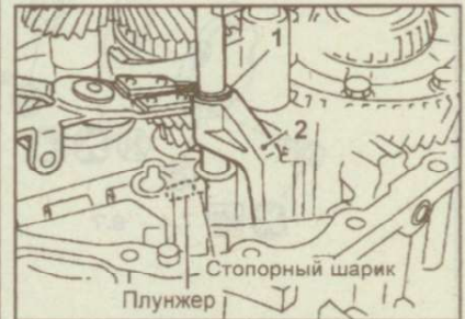
Рис. 9.47. Снятие стопорного кольца (1) кронштейна (2) вилки переключения 5-й передачи и передачи заднего хода
