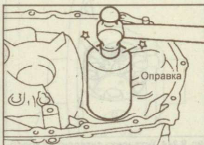
Рис. 9.252. Установка наружного кольца подшипника дифференциала
