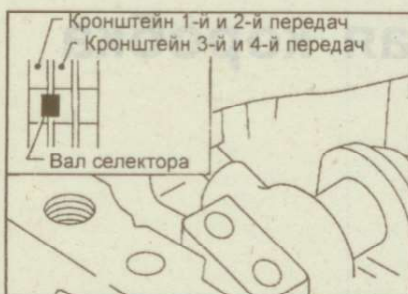
Рис. 9.277. Установка вала селектора в промежуточное положение между кронштейнами 1-й и 2-й передач и 3-й и 4-й передач
