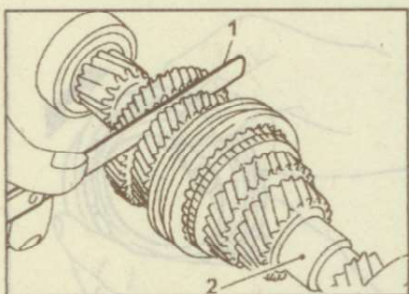
Рис. 9.62. Использование щупа (1) для измерения осевого люфта шестерен 3-й и 4-й передач первичного вала (2)
