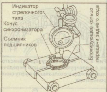
Рис. 9.209. Измерение износа блокирующего кольца передачи заднего хода
