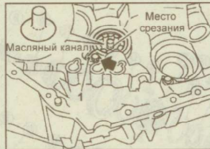
Рис. 9.52. Снятие держателя (1) подшипника вторичного вала
