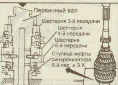
Рис. 9.219. Установка синхронизатора 5-й передачи и передачи заднего хода
