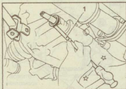
Рис. 9.12. Использование специального инструмента (1) для извлечения сальника тяги переключения передач
