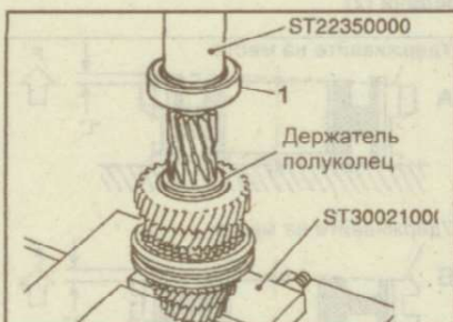
Рис. 9.85. Установка заднего подшипника (1) первичного вала
