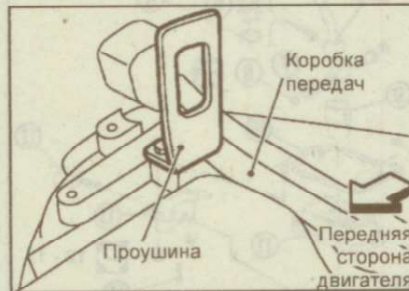
Рис. 9.27. Установка проушины для поддержки двигателя (задняя сторона)
