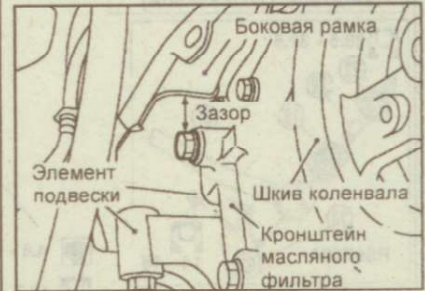
Рис. 9.28. Поднятие силового агрегата перед выворачиванием болтов крепления коробки передач
