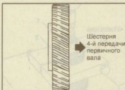
Рис. 9.82. Установочное положение шестерни 4-й передачи первичного вала
