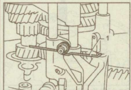
Рис. 9.270. Установка блокирующей пружины (1) передачи заднего хода на кронштейн 5-й передачи
