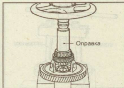
Рис. 9.250. Установка подшипника дифференциала
