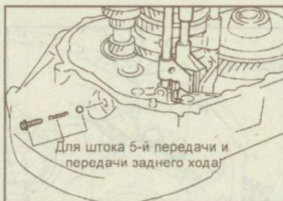
Рис. 9.269. Установка шарика, пружины и пробки механизма фиксации 5-й передачи и передачи заднего хода
