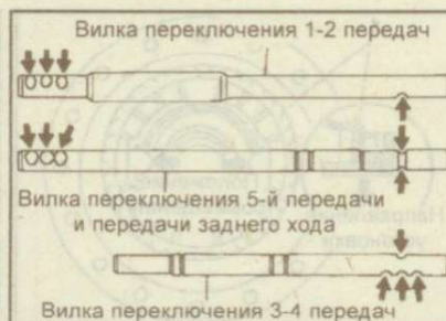
Рис. 9.138. Места проверки стопорных выемок штоков вилок переключения
