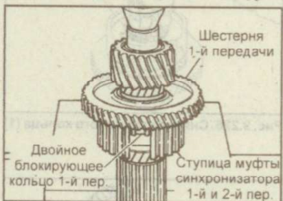
Рис. 9.234. Установка шестерни 1-й передачи, блокирующих колец и ступицы муфты синхронизатора 1-й и 2-й передач
