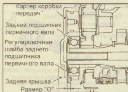
Рис. 9.166. Место измерения размера "O"
