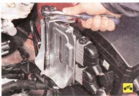
13. Выверните два болта крепления блока управления двигателем и отведите блок в сторону.
