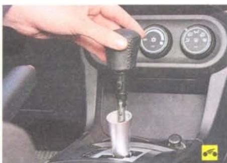
9. Снимите рукоятку рычага селектора вариатора.
