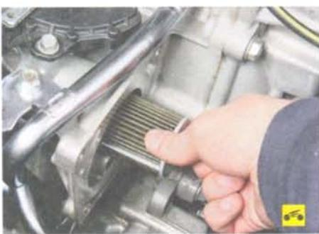
18. Извлеките фильтр рабочей жидкости из корпуса вариатора.
