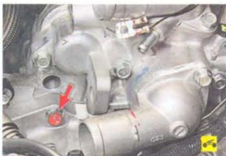
53. Выверните болты крепления коробки передач к двигателю, предварительно подставив под коробку передач надежную опору.
