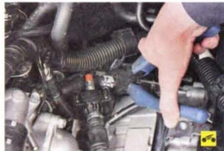
24. Сожмите отогнутые ушки хомута крепления к трубке шланга, подводящего жидкость от корпуса термостата, сдвиньте хомут по шлангу и отсоедините шланг от трубы.
