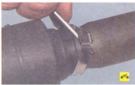
Динамический демпфер, закрепленный хомутом на валу привода, при эксплуатации обычно не выходит из строя. В случае замены вала новым, на котором не установлен демпфер, для его снятия достаточно снять хомут крепления так же, как это делали при снятии хомутов чехлов шарниров...
