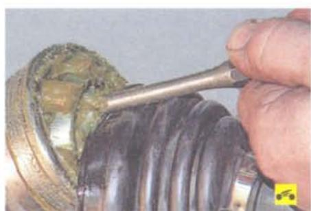
— наружный шарнир равных угловых скоростей должен поворачиваться с легким усилием, без рывков и заеданий, радиальных и осевых люфтов. При их наличии замените шарнир;
