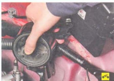
52. Снимите левую опору силового агрегата (см. «Замена левой опоры силового агрегата», с. 88).
