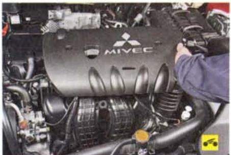
2. Снимите декоративный кожух двигателя (см. «Снятие и установка декоративного кожуха двигателя», с. 85).
