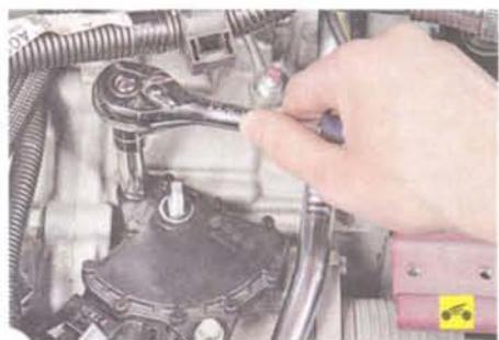
40. Выверните два болта крепления переключателя режимов работы вариатора...
