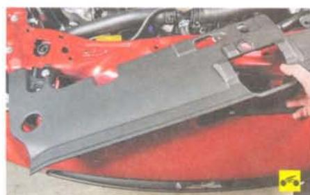
9. Снимите верхнюю декоративную панель бампера (см. «Снятие, разборка и установка переднего бампера», с. 230).
