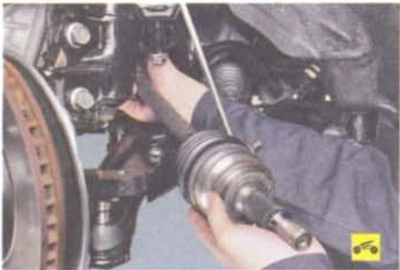
16. ...и снимите привод.
