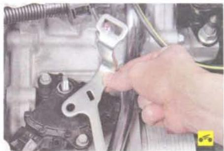
39. ...и снимите рычаг.
