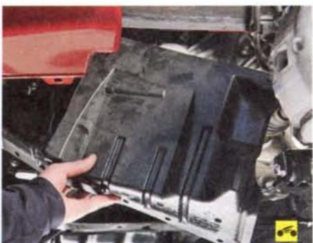
10. ...и правый брызговики двигателя (см. «Снятие и установка брызговиков и защиты картера двигателя», с. 85).
