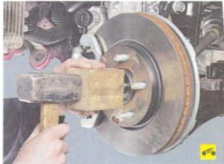
При затрудненном выведении хвостовика наружного шарнира аккуратно, не повреждая резьбы, выбейте его из ступицы молотком через выколотку или деревянный брускок подходящего размера.
