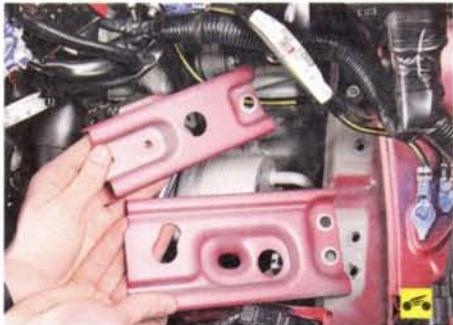
7. ...и полку крепления аккумуляторной батареи (см. «Снятие и установка полки крепления аккумуляторной батареи», с. 254).
