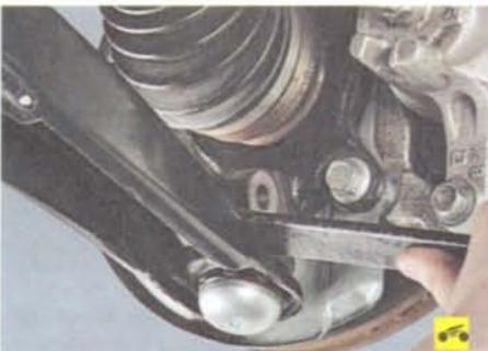
11. Отсоедините палец шаровой опоры от поворотного кулака (см. «Снятие и установка рычага передней подвески», с. 145).
