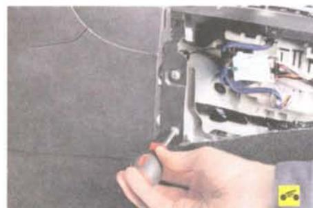
12. Выверните два задних винта крепления левой облицовочной панели центральной консоли панели приборов...
