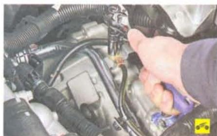
10. Выверните болт крепления «массового» провода к кронштейну трубы системы охлаждения.
