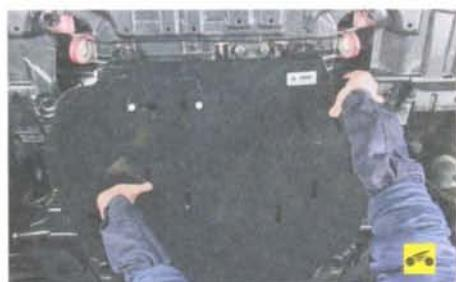
2. Снимите защиту картера двигателя и правый брызговик (см. «Снятие и установка брызговиков и защиты картера двигателя», с. 85).
