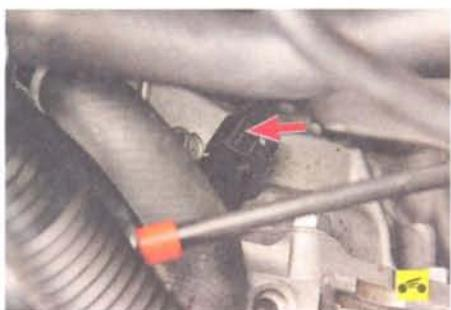
30. Отсоедините колодку жгута проводов от датчика скорости.
