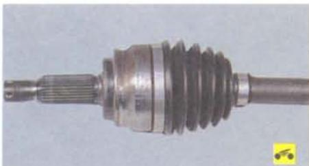
— наружный шарнир равных угловых скоростей должен поворачиваться с легким усилием, без рывков и заеданий, радиальных и осевых люфтов. При их наличии замените шарнир;
