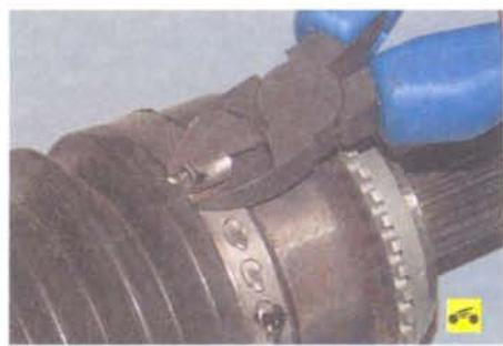
3. Отсоедините отверткой или перекусите бокорезами замок хомута крепления чехла наружного шарнира и снимите хомут.
