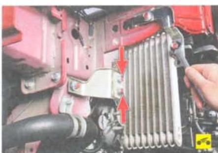
8. Выверните три болта крепления радиатора к кронштейну кузова...
