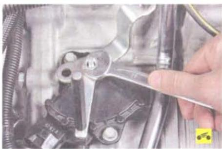
37. Не вынимая фиксатор, отверните гайку крепления рычага управления вариатором.
