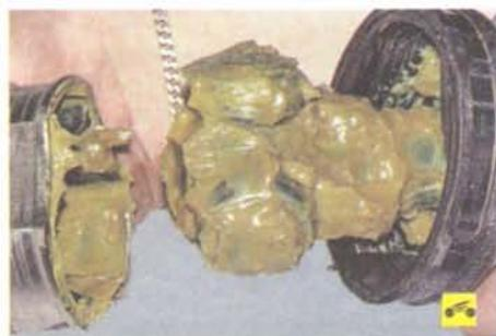
14. Отсоедините от привода корпус внутреннего шарнира.
