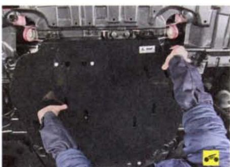
8. Вывернув четыре болта, снимите защиту двигателя...
