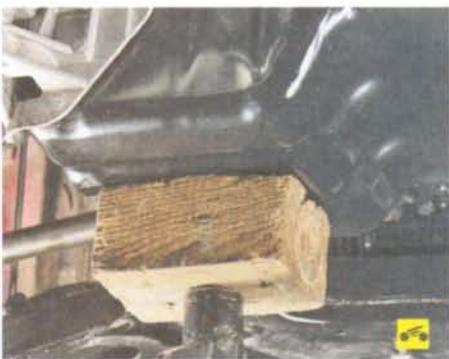
43. Установите под двигатель надежную опору или вывесите его с помощью грузоподъемного механизма.
