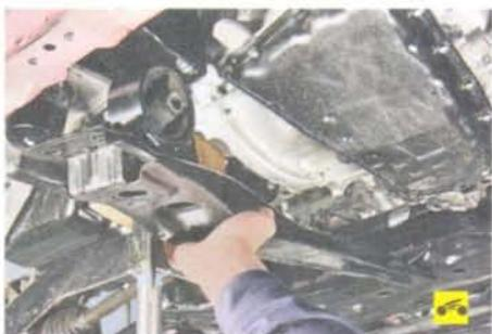
...и снимите брус с автомобиля.
