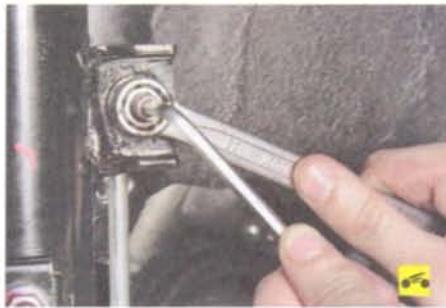
10. Придерживая от проворачивания палец верхнего шарнира стойки стабилизатора, отверните гайки крепления стоек и отсоедините верхние шарниры стоек стабилизатора от кронштейнов амортизаторных стоек (см. «Замена деталей стабилизатора поперечной устойчивости передней подвески», с. 145).
