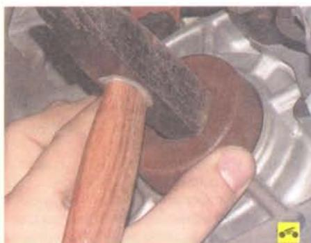
4. Смажьте трансмиссионным маслом рабочую кромку сальника и запрессуйте его опправкой подходящего диаметра рабочей кромкой внутрь коробки.
