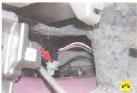
17. Выверните два винта крепления уплотнителя троса к панели тоннеля пола кузова (второй винт на фото не виден, он находится слева от троса), сдвиньте его вдоль троса и выньте трос вместе с уплотнителем в салон автомобиля.
