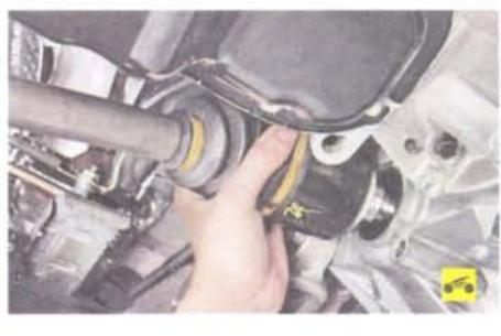
42. Отсоедините от коробки передач приводы передних колес (см. «Снятие
