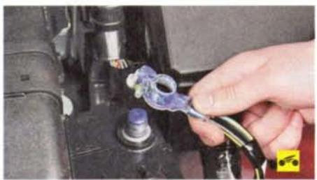
3. Отсоедините провод от клеммы «минус» аккумуляторной батареи.
