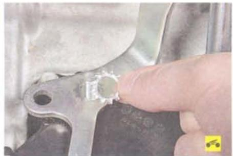
38. Снимите установленную под гайкой зубчатую шайбу...
