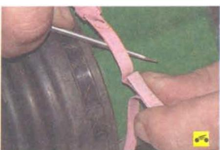
12. Для разборки и замены внутреннего шарнира снимите хомуты крепления чехла шарнира к его корпусу...
