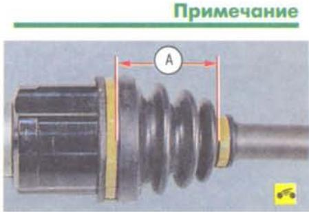
**При установке чехла внутреннего шарнира во избежание нарушения герметичности шарнира в эксплуатации обеспечьте расстояние A, равное  $(80 \pm 3)$  мм, между его хомутами (при полностью сжатом в осевом направлении шарнире).**
