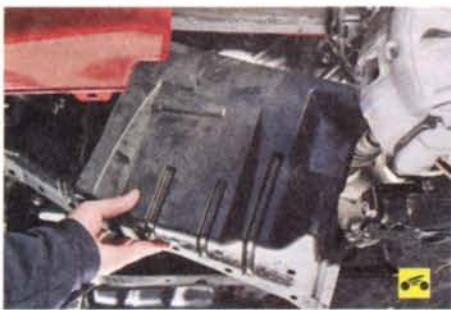
16. ...и левый брызговики двигателя (см. «Снятие и установка брызговиков и защиты картера двигателя», с. 85).
