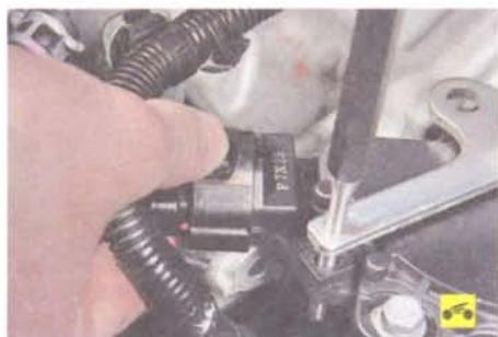
35. Сожмите фиксатор колодки жгута проводов переключателя режимов работы вариатора...
