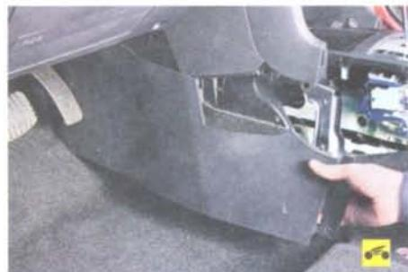
14. ...и снимите облицовочную панель.
