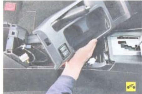
10. Снимите верхнюю облицовочную панель тоннеля пола...
