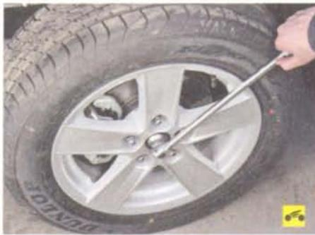
7. Ослабьте затяжку гайки ступицы переднего колеса.
