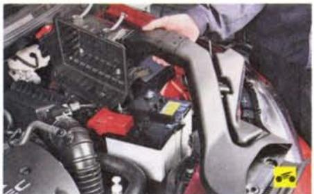
4. Снимите воздушный фильтр (см. «Снятие и установка воздушного фильтра», с. 115).
