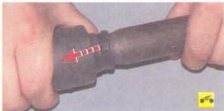
...и снять демпфер с вала, преодолевая трение массива резины демпфера о вал.
