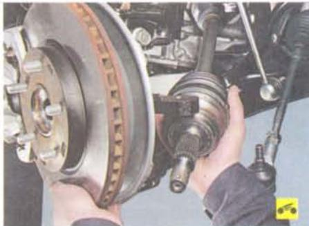
2. Для замены сальника полуоси снимите привод колеса со стороны заменяемого сальника (см. «Снятие и установка приводов передних колес», с. 139).
