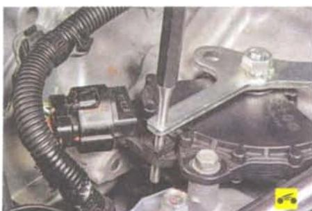
3. Зафиксируйте механизм переключения режимов.
