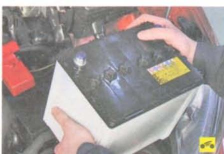
5. Снимите аккумуляторную батарею (см. «Снятие и установка аккумуляторной батареи», с. 187)...
