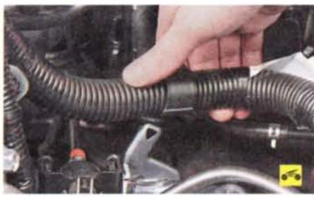
22. ...и снимите жгут с кронштейна картера коробки передач.
