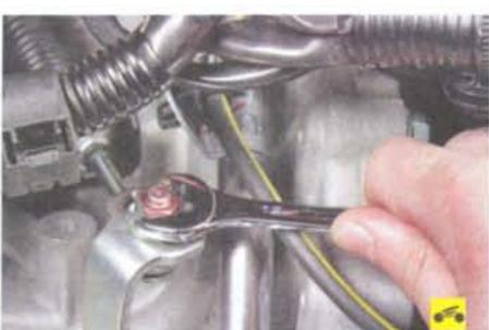
4. Отверните гайку крепления наконечника троса привода управления вариатором...
