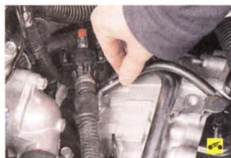
25. Снимите шланг с патрубка сапуна коробки передач...
