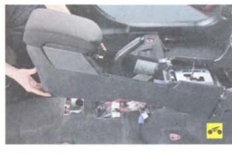
11. ...и облицовку тоннеля пола с подлокотником (см. «Снятие и установка облицовки тоннеля пола», с. 247).
