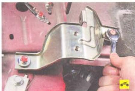
14. Выверните два болта крепления нижнего кронштейна радиатора и снимите кронштейн.
