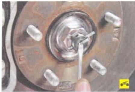
4. Разогните усики шплинта гайки ступицы...
