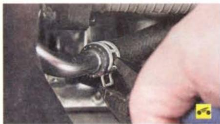
19. Сожмите пассатижами ушки хомута крепления шланга теплообменника вариатора к трубке системы охлаждения, сдвиньте хомут вдоль шланга...
