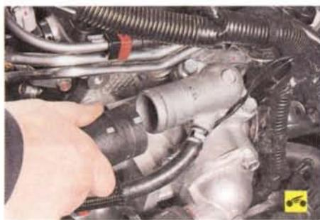
18. Слейте охлаждающую жидкость, отсоедините и снимите трубы системы охлаждения, подвешенные к корпусу термостата (см. «Снятие и установка корпуса термостата в сборе», с. 105).
