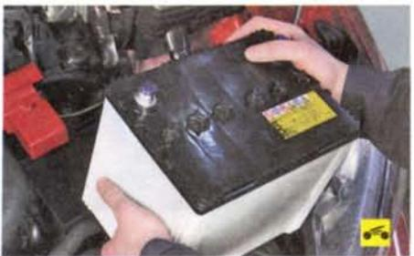
5. Снимите аккумуляторную батарею (см. «Снятие и установка аккумуляторной батареи», с. 187)...
