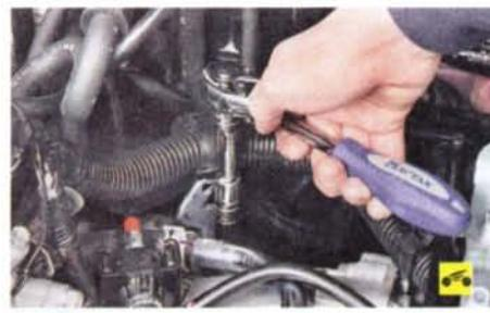
23. Выверните задний болт крепления трубы системы охлаждения.
