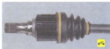
— внутренний шарнир должен перемещаться в угловых и осевых направлениях с легким усилием, при этом не должно ощущаться рывков, заеданий и радиальных люфтов. В противном случае замените внутренний шарнир;
