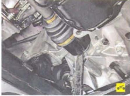
14. С помощью монтажной лопатки выпрессуйте хвостовик внутреннего шарнира из шестерни полуоси дифференциала...
