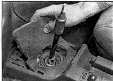
Рис. 2.5. Снимите звукоизолирующую прокладку
