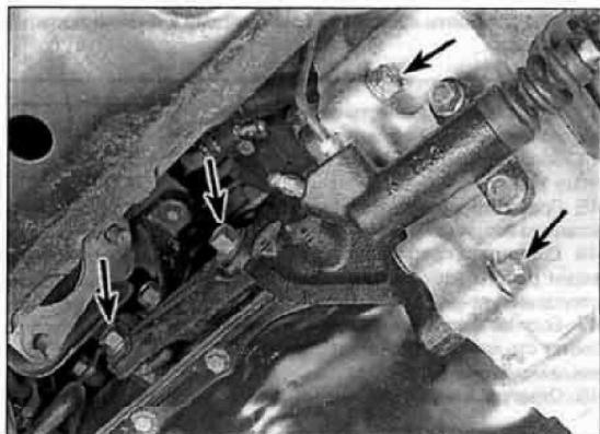
Рис. 4.27. На модели с 4-цилиндровым двигателем выверните болты (показаны стрелками) и отсоедините кронштейн опоры двигателя
