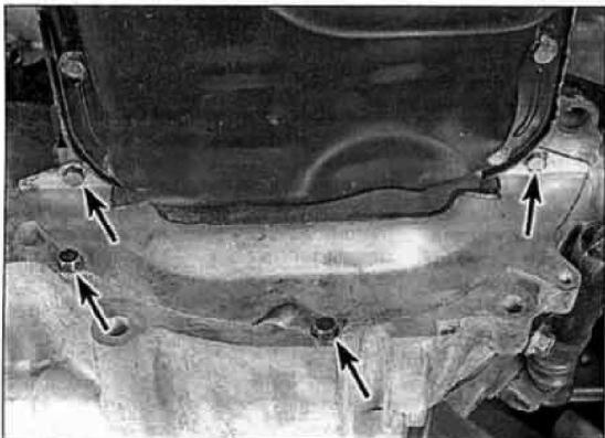
Рис. 4.24. Выверните болты (показаны стрелками) и снимите щиток картера сцепления
