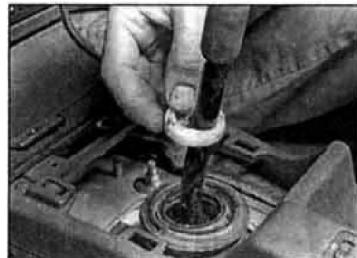
Рис. 2.7. Снимите верхнюю опору шарового шарнира
