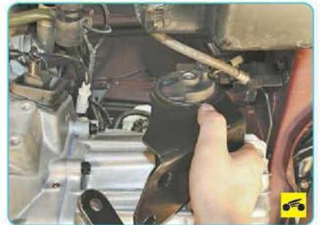
24. ...открутите гайки крепления опоры к коробке передач и снимите левую опору подвески силового агрегата.
