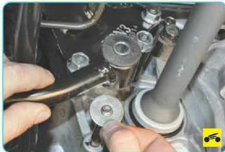
7. ...и снимите реактивную тягу со шпильки коробки передач.
