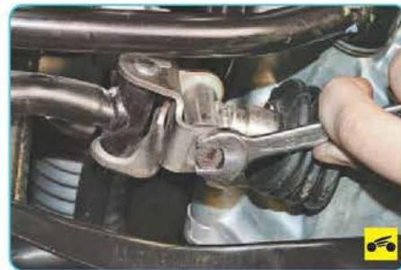
14. ...выверните болт крепления тяги привода...
