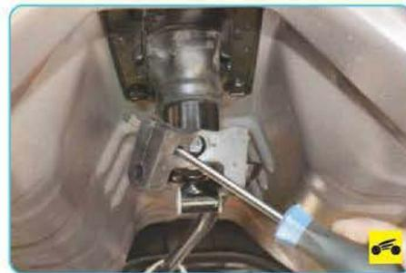
11. Снимите буфер с оси рычага...
