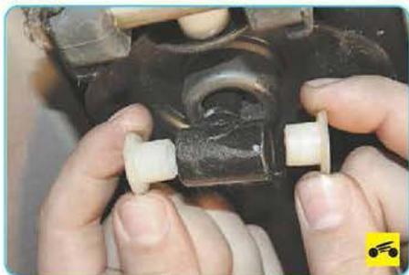
3. Извлеките из проушины рычага пластмассовые втулки. Сломанные или изношенные втулки замените.
