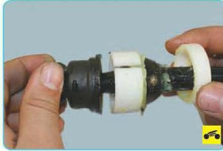
20. Снимите с рычага пластмассовые и резиновые втулки. Осмотрите втулки и шайбы. Если на втулках есть следы износа или появились признаки старения, замените их.
