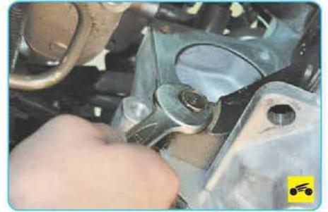
22. ...и болт заднего крепления коробки передач к блоку цилиндров.
