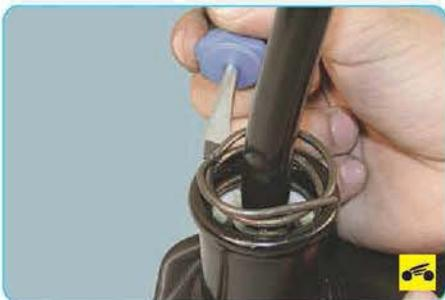
18. Подденьте фиксирующую пружину рычага...
