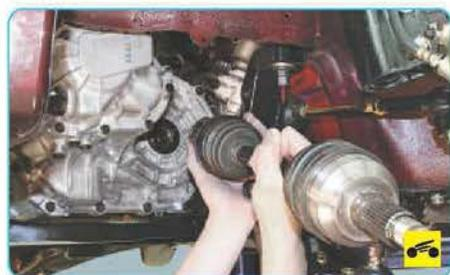
2. Для замены сальника полуоси снимите привод колеса со стороны заменяемого саль-
