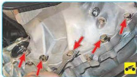
18. Выверните пять болтов нижнего крепления коробки передач к двигателю.
