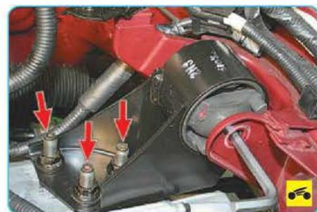
7. Ослабьте затяжку гаек шпилек крепления левой опоры силового агрегата, выверните болт крепления левой опоры к кронштейну на кузове и вставьте на место болта оправку подходящего размера (см. «Замена опор подвески силового агрегата», с. 74).
