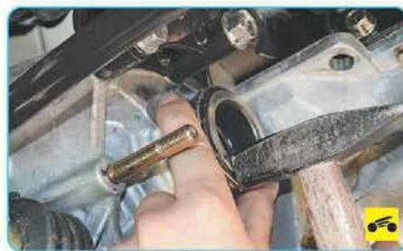
4. Смажьте рабочую кромку сальника трансмиссионным маслом и запрессуйте его оправкой подходящего диаметра рабочей кромкой внутрь коробки.
