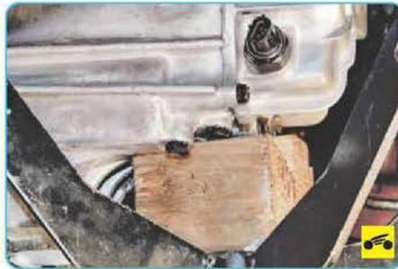
17. Аккуратно поддомкратьте или подвесьте двигатель и коробку передач, снимите переднюю и заднюю опоры силового агрегата (см. «Замена опор подвески силового агрегата», с. 74) и защитный брус (см. «Замена защитного бруса», с. 75).
