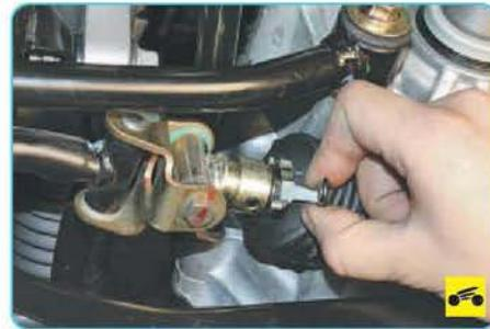
13. Снимите фиксирующую пластину болта крепления тяги привода...
