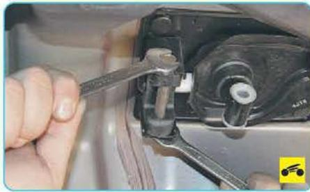
8. Отверните гайку болта крепления рычага переключения передач...
