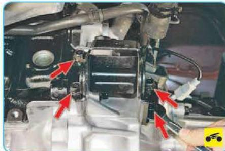
19. Выверните четыре болта крепления кронштейна передней опоры двигателя...
