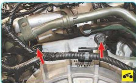
16. Выверните два болта верхнего крепления коробки передач к двигателю и отведите
