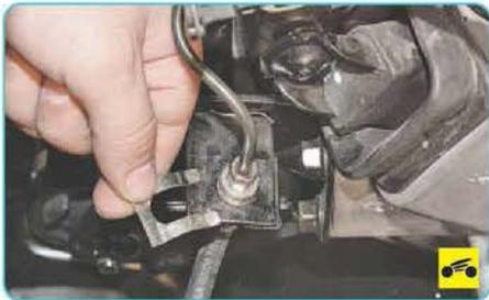
12. Извлеките фиксирующую скобу, протолкните вниз гибкий шланг...
