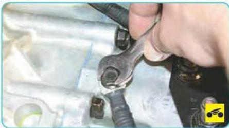
14. Выверните болт крепления клеммы провода «массы»...
