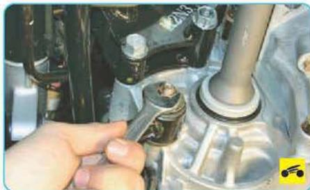
5. Отверните гайку крепления реактивной тяги к коробке передач...
