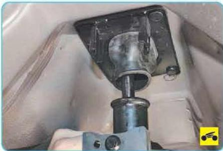
17. ...и снимите рычаг переключения передач, выводя его вниз.
