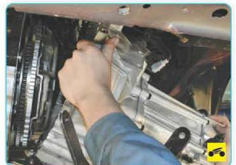
25. Сдвиньте коробку передач влево, уберите опору из-под коробки передач и снимите ее.
