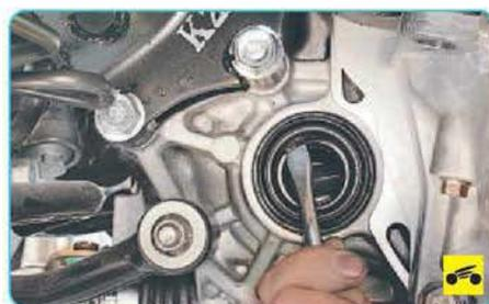
3. Извлеките сальник монтажной лопаткой или отверткой с плоским лезвием.
