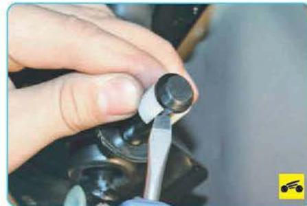
12. ...и снимите пластмассовую втулку с оси рычага переключения передач.
