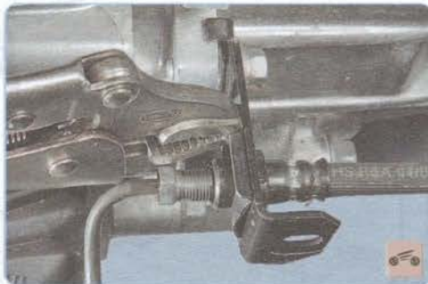
3. Снимите фиксирующую скобу...
