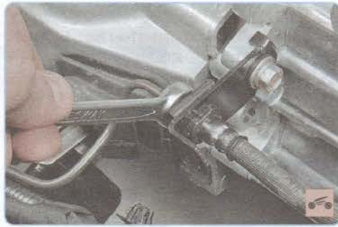
1. Отверните гайку крепления трубки к наконечнику шланга...
