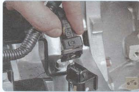
18. Отсоедините колодки жгута проводов датчика скорости...
