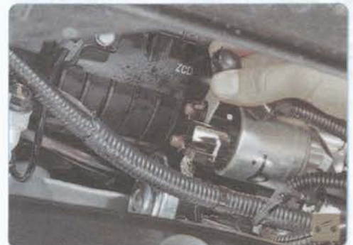
26. Снимите защитный колпачок наконечника силового провода, отверните гайку и отсоедините наконечник от контактного болта стартера.
