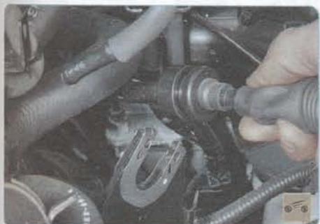
16. ...и наконечник троса с оси рычага выбора передач.
