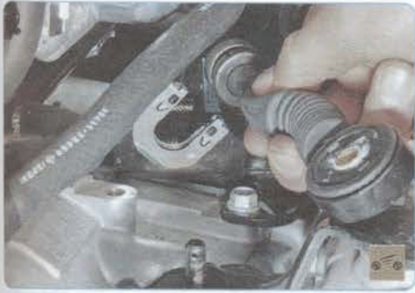
13. Извлеките наконечник оболочки троса из прорези кронштейна на коробке передач. Отведите трос переключения передач в сторону.
