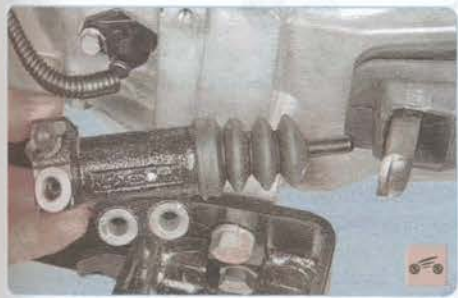
3. Выверните два болта крепления рабочего цилиндра к картеру сцепления...
