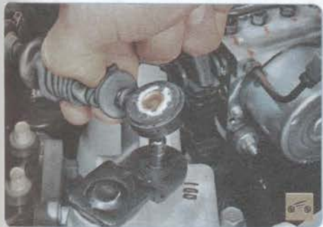
16. ...и наконечник троса с оси рычага выбора передач.
