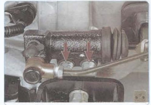
23. Выверните два болта крепления рабочего цилиндра к картеру сцепления и отведите цилиндр в сторону.
