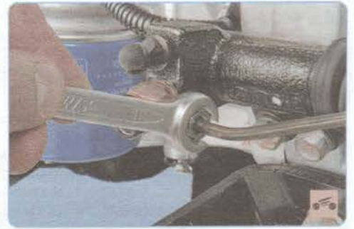
6. Для замены трубки гидропривода отверните гайку крепления трубки к штуцеру рабочего цилиндра...
