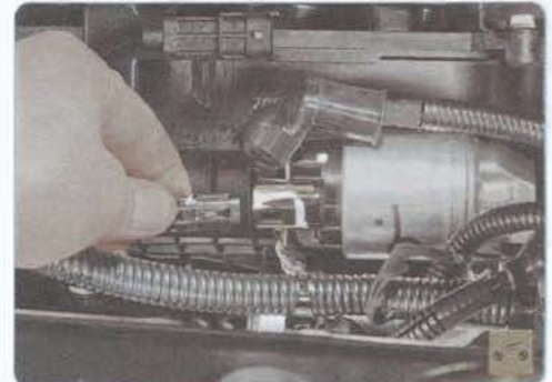
25. Отсоедините колодку управляющего провода от вывода тягового реле стартера.
