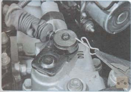
14. Извлеките шплинт крепления наконечника троса из отверстия оси рычага выбора передач...
