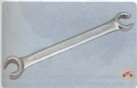
...и специальный ключ «на 11» для гаек трубопроводов.
