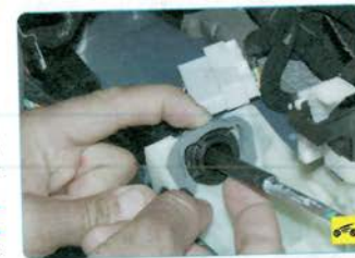
3. Отожмите пальцем пластмассовый фиксатор...
