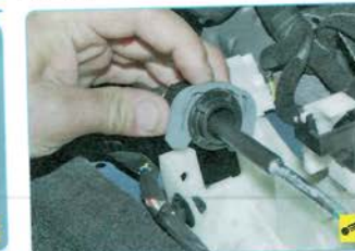
4. ...и извлеките наконечник оболочки троса управления коробкой передач из паза в корпусе кулисы селектора.
