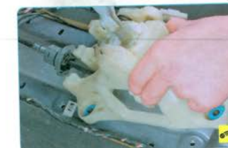
11. Отведите кронштейн рычага переключения передач и разверните его.
