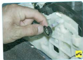
2. Отсоедините наконечник троса привода управления коробкой передач от рычага селектора выбора передач.
