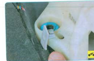
10. ...снимите держатель жгута проводов из корпуса кронштейна рычага переключения передач и отведите вместе со жгутом в сторону.
