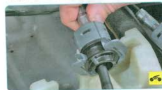
14. Извлеките из паза в корпусе кронштейна рычага переключения передач наконечник троса переключения передач.
