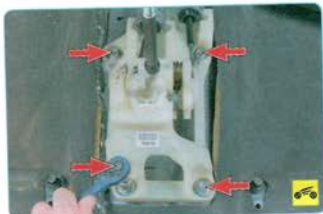
8. Выверните четыре болта крепления корпуса кулисы к основанию кузова.
