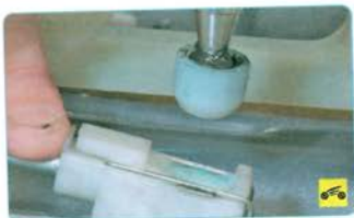
13. Отсоедините наконечник троса от шарнира рычага переключения передач.
