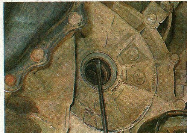
4. Осматриваем поверхность на корпусе внутреннего шарнира, по которой работает рабочая кромка сальника. На ней не должно быть видимых и ощущаемых пальцем повреждений, а также кольцевой выра-
