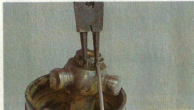
6. Легкими ударами молотка с резиновым бойком сдвигаем шарнир по шлицам вала и снимаем его.
