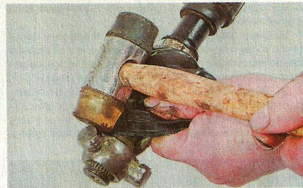
7. Снимаем чехол внутреннего шарнира с вала привода.
