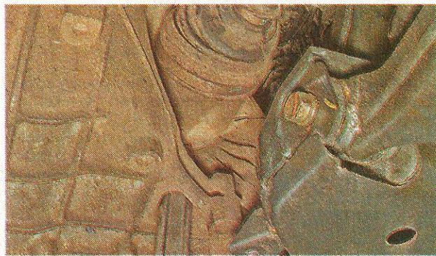
15. Поддерживая внутренний шарнир привода, чтобы не повредить сальник шлицами хвостовика, извлекаем шарнир из коробки передач и снимаем привод в сборе с автомобиля.
