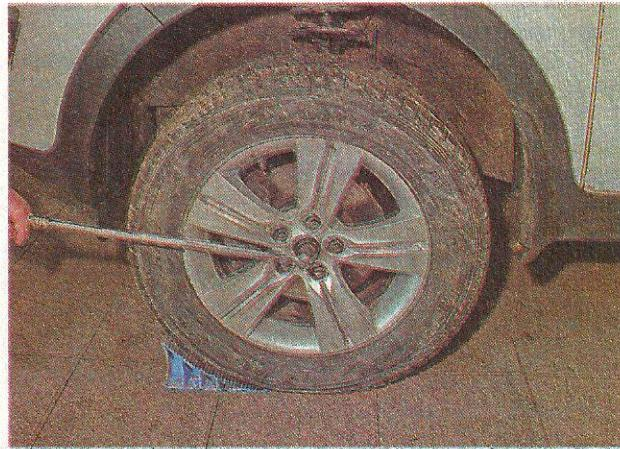
7. Устанавливаем автомобиль на надежную подставку и снимаем переднее колесо (см. «Замена колеса»).
