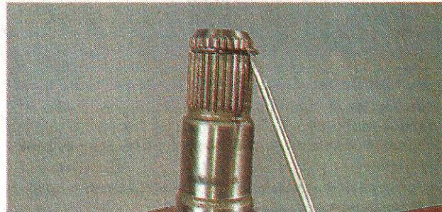
17. Используя накидной ключ подходящего размера в качестве оправки, устанавливаем новое стопорное кольцо в кольцевую проточку шлицевого конца вала.
