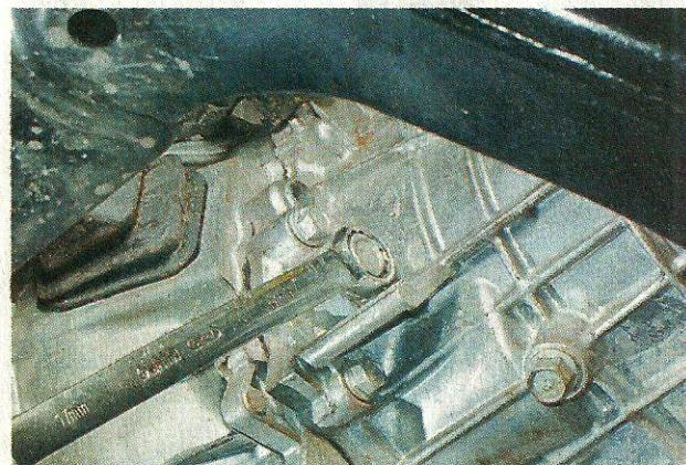
4. Бумажной полосой, свернутой трубкой или стержнем, проверяем уровень масла: он должен находиться у нижней кромки контрольного отверстия (см. рис.).
