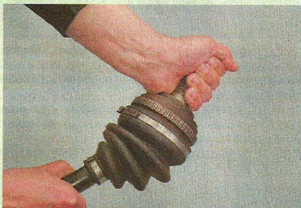
Неисправный шарнир следует заменить (либо отдельно, либо весь привод в сборе). Заменять только порванный чехол следует в том случае, если шарнир исправен.
