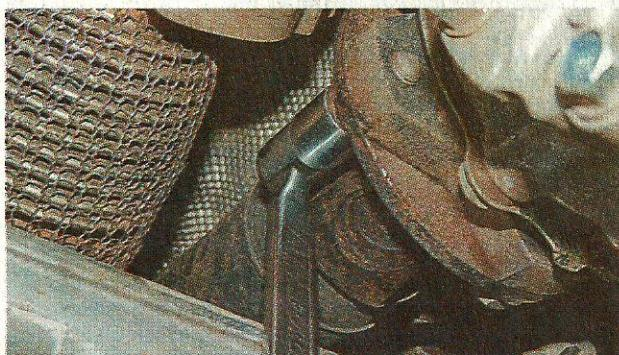
6. Устанавливаем подставку под передний вал карданной передачи.
