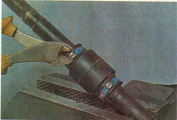
5. Разрезаем бокорезами или разъединяем тонкими плоскогубцами внешний и внутренний хомуты чехла наружного шарнира так же, как при замене чехла внутреннего шарнира (см. выше). Снимаем чехол, сдвигая его по валу.
