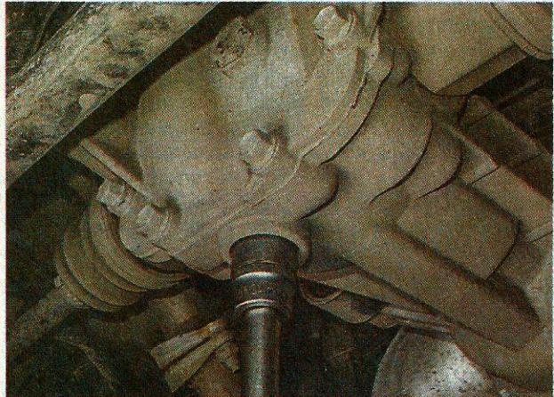
4. Дождавшись, когда масло перестанет вытекать из отверстия, заворачиваем на место пробку с новой уплотнительной прокладкой.
