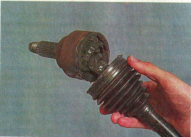
10. Сдвигаем защитный чехол в сторону шарнира так, чтобы большой уплотнительный пояс защитного чехла полностью наделся на корпус шарнира, а малый уплотнительный пояс встал в проточку вала.
