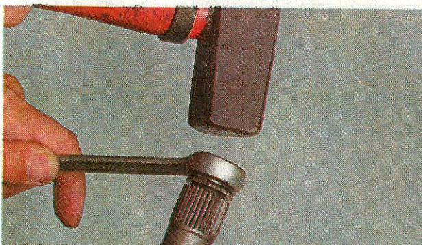
18. Наносим пластичную смазку на шлицевую и гладкую (по которой работает сальник) поверхности хвостовика.
