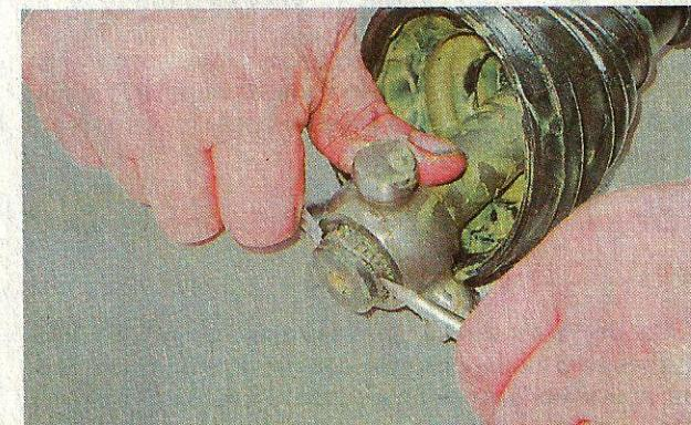
13. Заполняем корпус шарнира смазкой.
