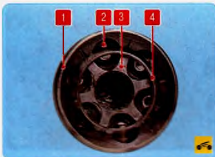
Рис. 6.10. Расположение сальника полуоси заднего моста: 1 – вал полуоси; 2 – стопорное кольцо; 3 – сальник полуоси; 4 – подшипник
