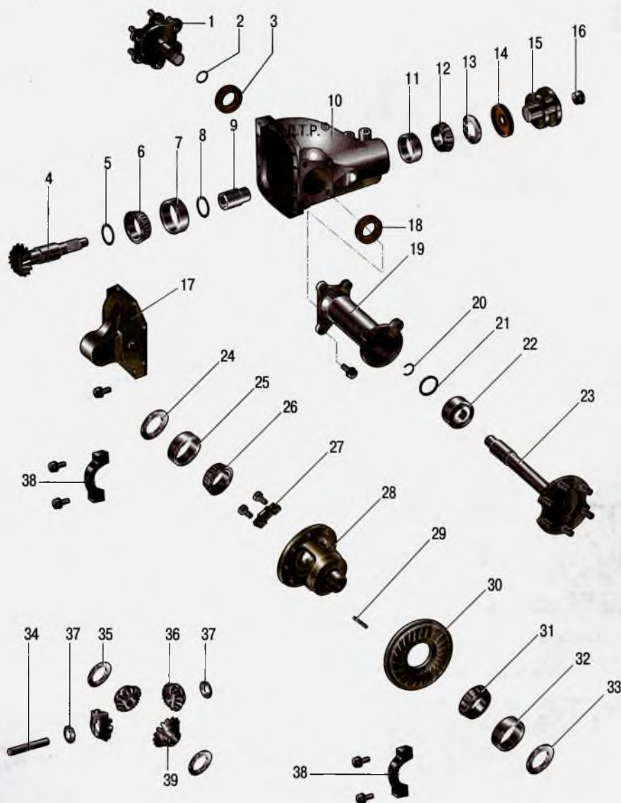
Рис. 6.8. Детали редуктора привода передних колес: 1 – правая полуось; 2, 20 – стопорное кольцо; 3, 18 – сальник полуоси; 4 – ведущая шестерня главной передачи; 5, 8, 24, 33 – регулировочная шайба; 6, 7 – подшипник; 9 – кожух; 10 – картер редуктора привода передних колес; 11, 12 – подшипник; 13 – маслоотражатель; 14 – сальник; 15 – фланец с пыльником; 16 – гайка; 17 – крышка редуктора привода передних колес; 19 – корпус левой полуоси; 21 – фиксирующее кольцо; 22 – подшипник; 23 – левая полуось; 25, 26, 31, 32 – подшипник; 27 – стопорная пластина; 28 – корпус дифференциала; 29 – шпилька; 30 – ведомая шестерня главной передачи; 34 – ось сателлитов; 35 – упорная шайба шестерни полуоси; 36 – сателлит; 37 – упорная шайба сателлита; 38 – крышка подшипника; 39 – шестерня полуоси
