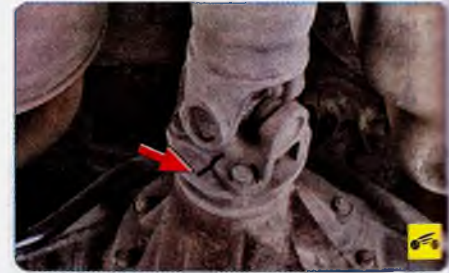
Рис. 6.7. Карданный шарнир: 1 – труба вала; 2 – вилка вала; 3 – крестовина; 4 – стопорное кольцо; 5 – корпус игольчатого подшипника; 6 – задняя вилка
