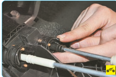
Рис. 6.5. Крепление уплотнителя тросов управления коробкой передач
