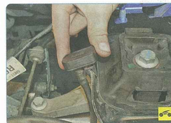
51. Снимите с края обоймы левой опоры силового агрегата сапун коробки передач.
