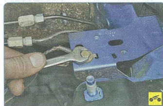
47. Выверните болт крепления «массовых» проводов к кронштейну кузова...
