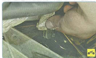
43. Отсоедините колодку жгута проводов от датчика скорости (см. «Проверка и замена датчиков системы управления двигателем», с. 227).
