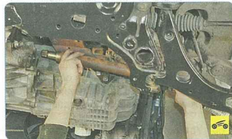
37. ...и снимите привод правого переднего колеса в сборе.
