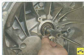
7. Сальник первичного вала заменяют на снятой с автомобиля коробке передач после снятия рабочего цилиндра привода выключения сцепления с подшипником выключения сцепления (см. «Замена рабочего цилиндра привода выключения сцепления с подшипником выключения сцепления», с. 148). Извлеките сальник отверткой (или специально изготовленным проволочным крючком).
