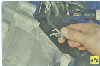
42. ...отсоедините от картера коробки передач держатель жгута проводов выключателя света заднего хода и отведите жгут в сторону.
