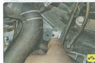
45. Выверните болт крепления кронштейнов шлангов к картеру коробки передач...
