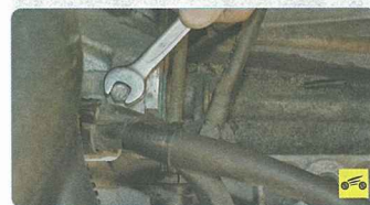
45. Выверните болт крепления кронштейнов шлангов к картеру коробки передач...
