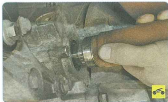
36. Извлеките хвостовик внутреннего шарнира из полуосевой шестерни...
