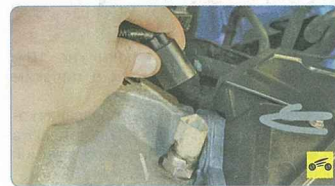
40. Отсоедините колодку жгута проводов от выключателя света заднего хода.
