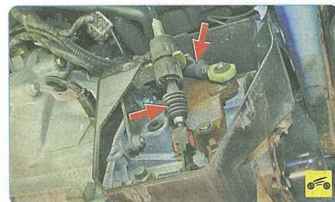
38. Отсоедините от коробки передач тросы управления коробкой передач (см. «Замена тросов управления механической коробкой передач», с. 156).
