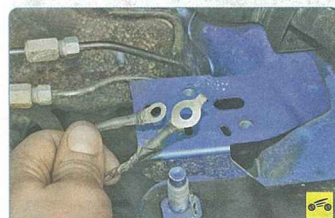
48. ...отсоедините провода от кронштейна и отведите их в сторону.
