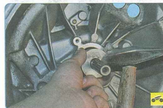
7. Сальник первичного вала заменяют на снятой с автомобиля коробке передач после снятия рабочего цилиндра привода выключения сцепления с подшипником выключения сцепления (см. «Замена рабочего цилиндра привода выключения сцепления с подшипником выключения сцепления», с. 148). Извлеките сальник отверткой (или специально изготовленным проволочным крючком).
