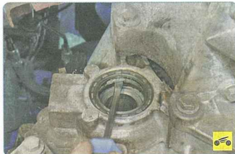
3. Извлеките сальник отверткой.
