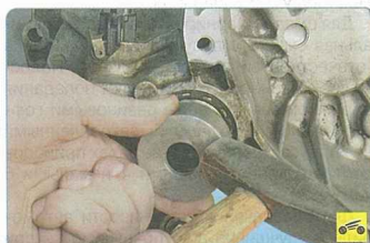
4. Смажьте рабочую кромку сальника трансмиссионной смазкой и запрессуйте его оправкой подходящего диаметра рабочей кромкой внутрь коробки.
