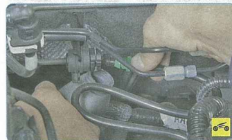
44. Отсоедините шланг гидропривода выключения сцепления от трубки гидропривода.
