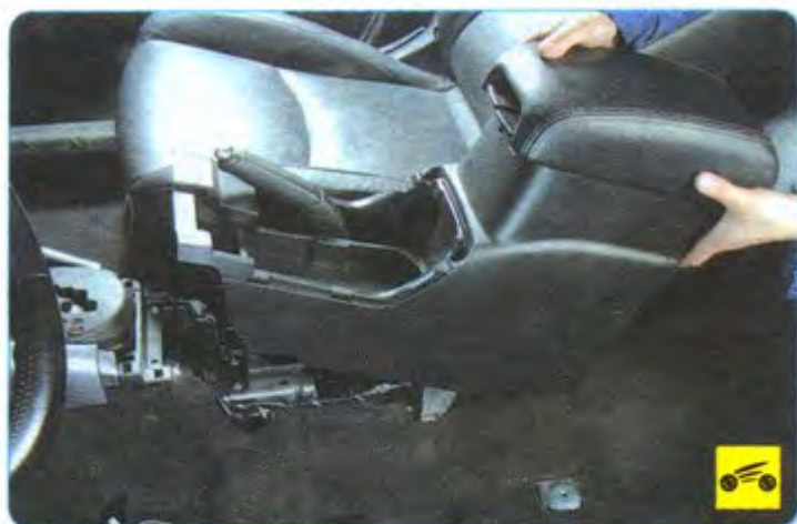
4. Снимите заднюю часть облицовки тоннеля пола с подлокотником (см. «Снятие и установка облицовки тоннеля пола», с. 330).
